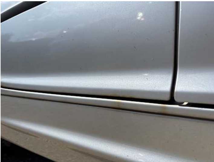
Türe hinten rechts (Rost)
