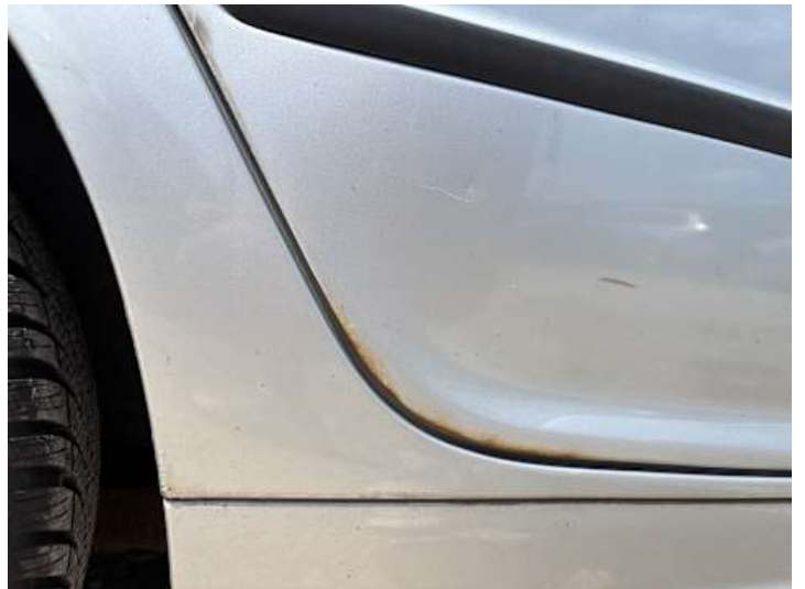
Türe hinten rechts (Rost)
