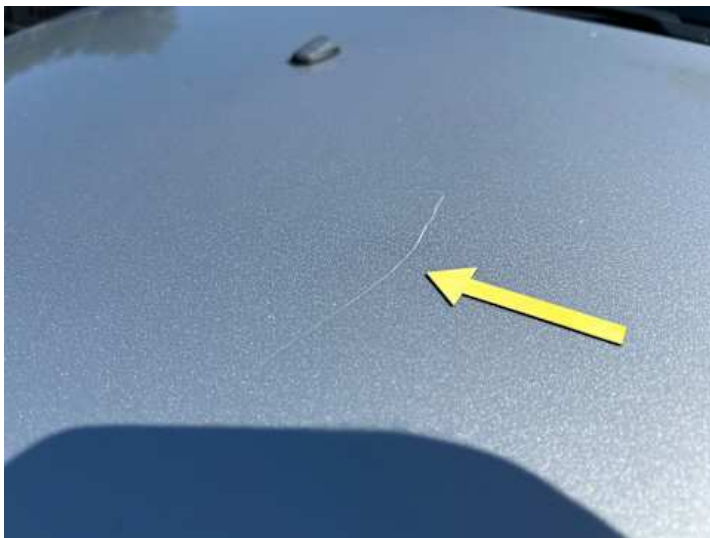
Motorhaube (Lackschaden, Kratzer)
