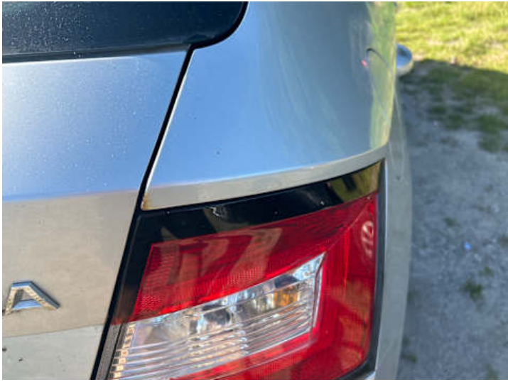
Seitenteil hinten rechts (Rost)
