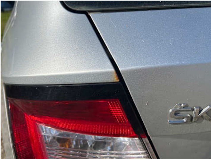
Seitenteil hinten links (Rost)
