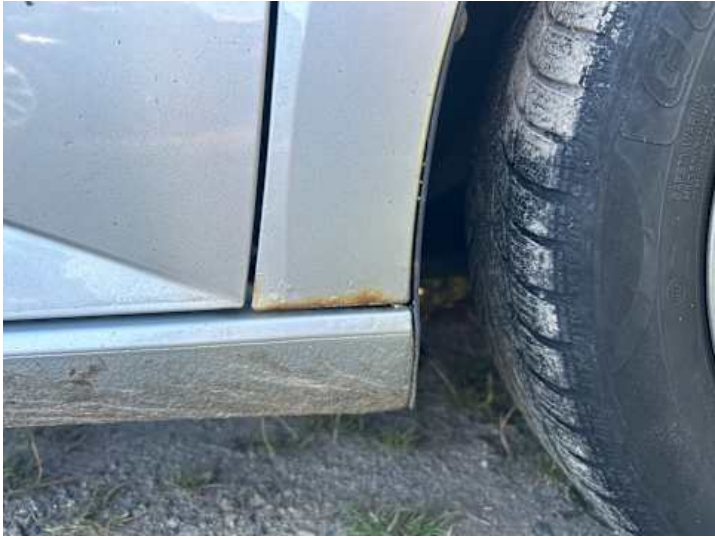
Kotflügel vorne rechts (Rost)
