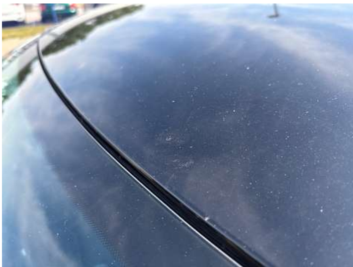
Dach (Lackschaden, Steinschlag)
