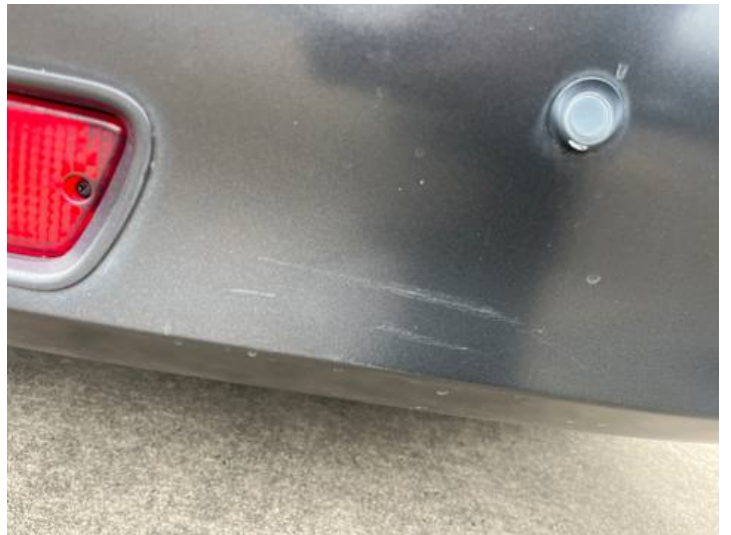
Stoßstange hinten (Kratzer)
