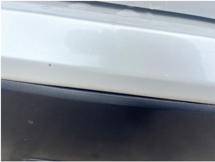
Stoßstange hinten (Spaltmaße ungenau)
