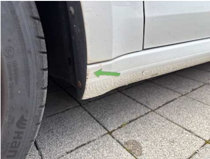
Schweller links (Rost)
