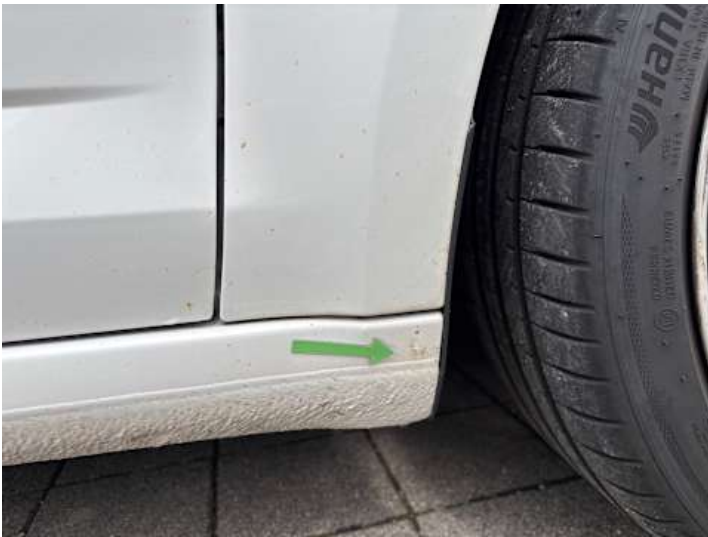
Schweller rechts (Rost)
