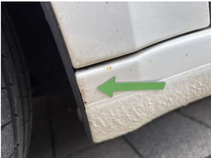
Schweller links (Rost)
