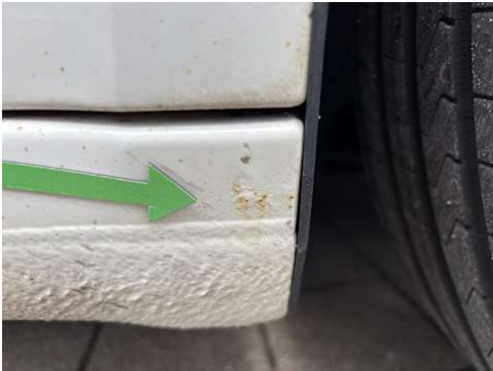
Schweller rechts (Rost)
