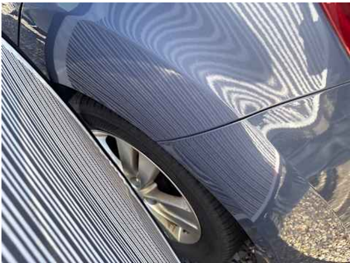
Seitenteil hinten links (Lackschaden)
