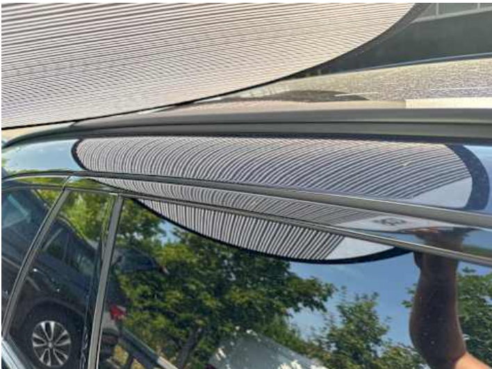
Dach (Anderer Schaden): Dachholm leicht wellig
