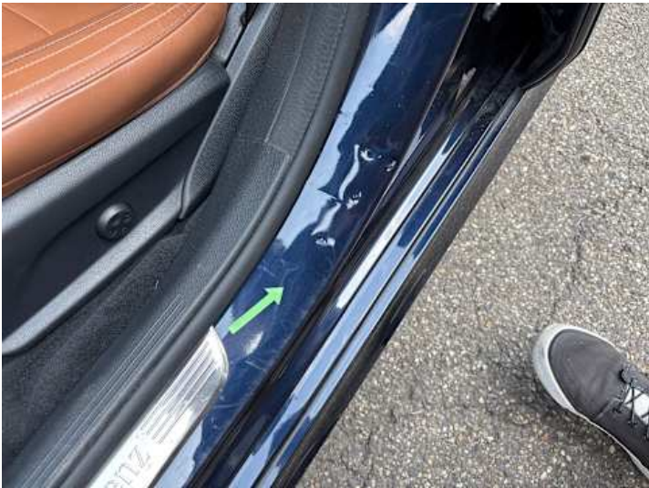
Schweller links (Kratzer, Delle)
