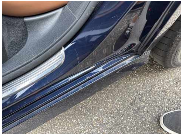
Schweller links (Kratzer, Delle)
