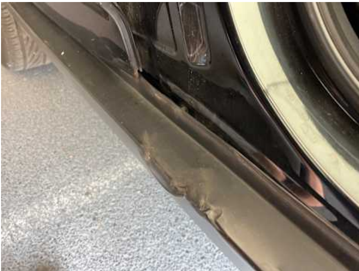
Schweller rechts (Verformung)
