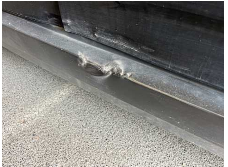
Schweller rechts (Verformung, Kratzer)
