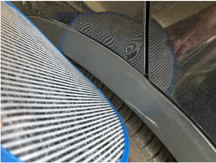
Seitenteil hinten rechts (Kratzer, Verformung)
