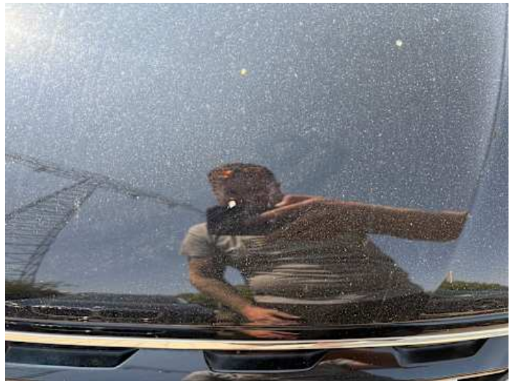
Motorhaube (Steinschlag, Lackschaden)
