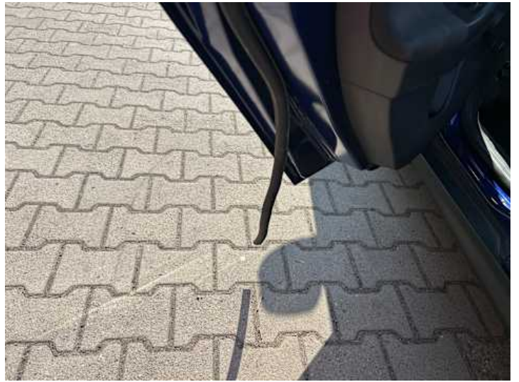
Türe hinten links (Anderer Schaden): Dichtgummi lose
