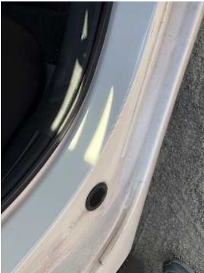
Türe hinten rechts (Kratzer, Lackschaden)
