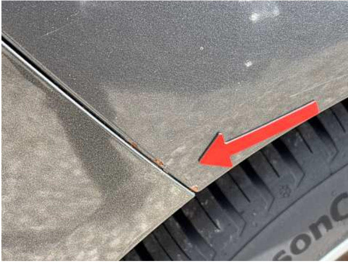
Seitenteil hinten rechts (Rost, Lackschaden)
