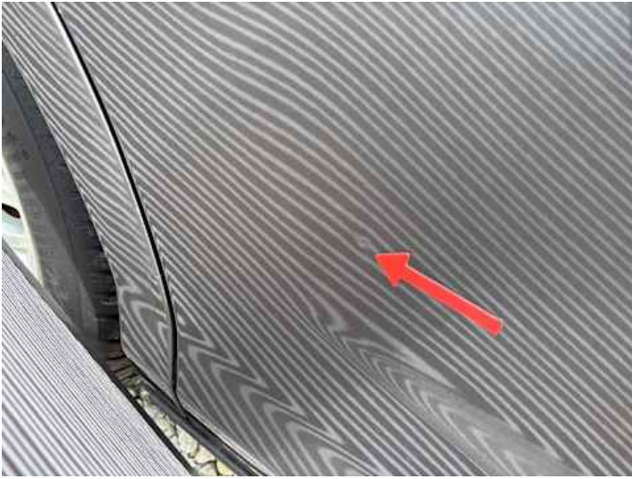
Türe hinten rechts (Steinschlag, Delle)
