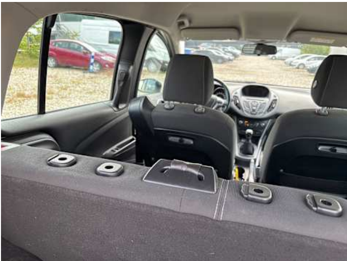
Innenraum (Anderer Schaden): Kopfstützen fehlen.
