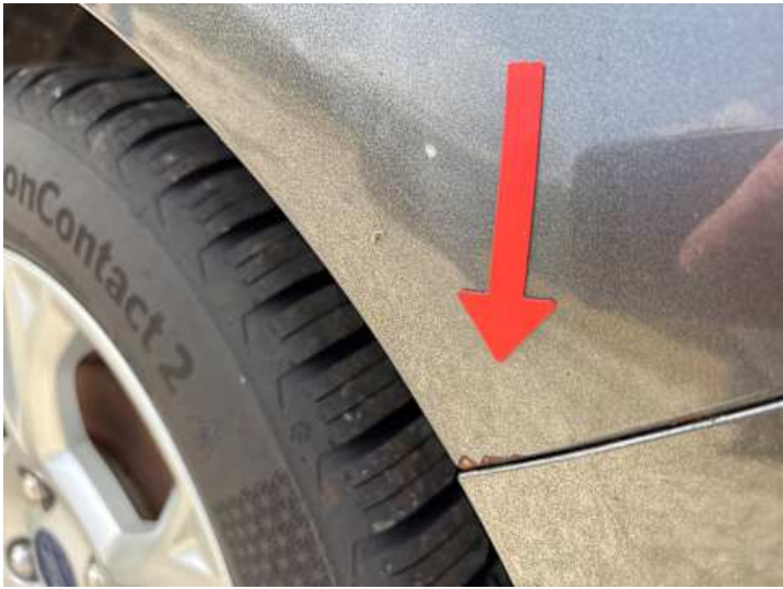
Seitenteil hinten links (Rost, Lackschaden)
