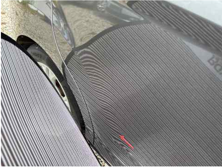
Türe hinten rechts (Steinschlag, Delle)
