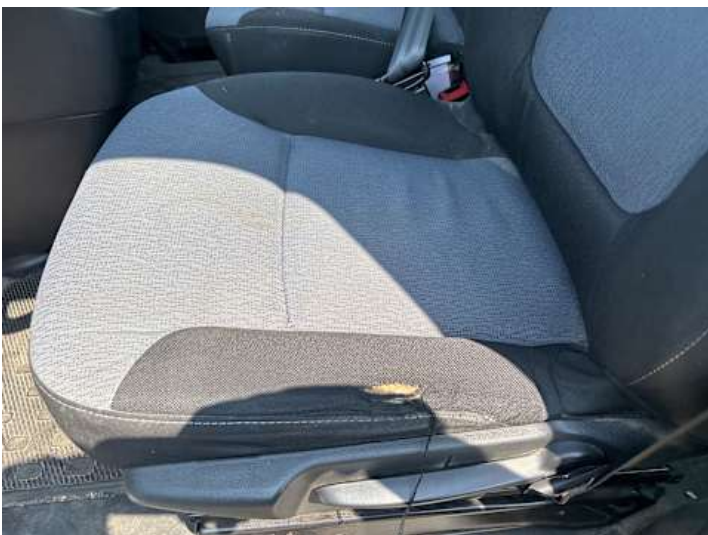
Innenraum (Verschleiß, Riss/Bruch)
