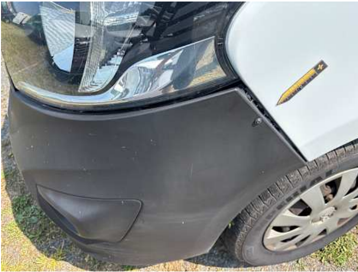
Stoßstange vorne (Riss/Bruch, Spaltmaße ungenau)
