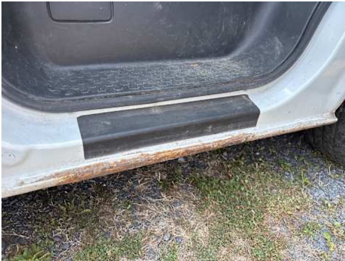
Schweller rechts (Rost, Lackschaden)
