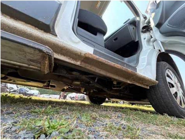
Schweller rechts (Rost, Lackschaden)
