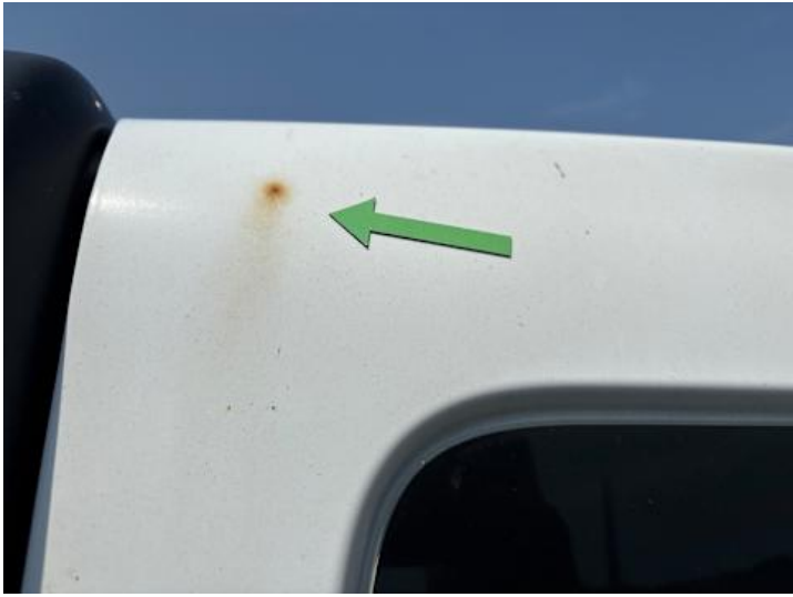
Heckklappe (Lackschaden, Rost, Delle)
