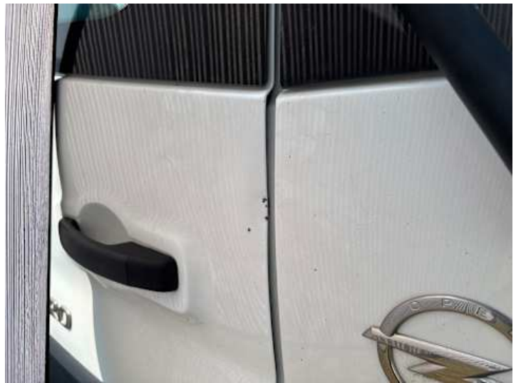
Heckklappe (Verformung, Kratzer)
