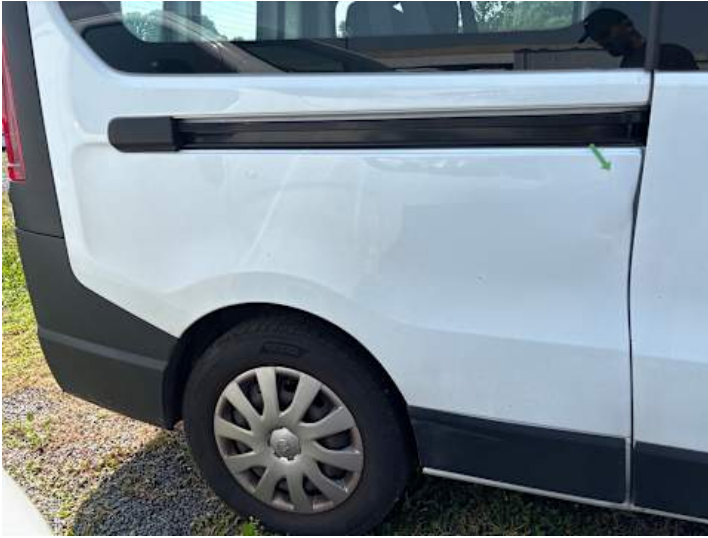
Seitenteil hinten rechts (Verformung)
