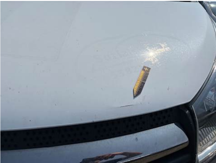
Motorhaube (Verformung, Kratzer, Lackschaden)
