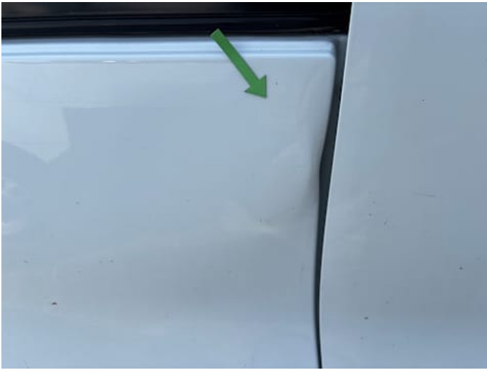
Seitenteil hinten rechts (Verformung)
