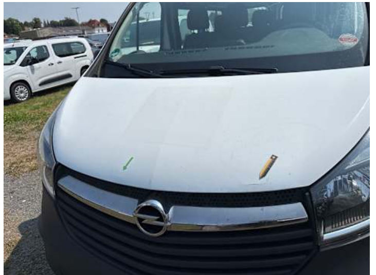
Motorhaube (Verformung, Kratzer, Lackschaden)
