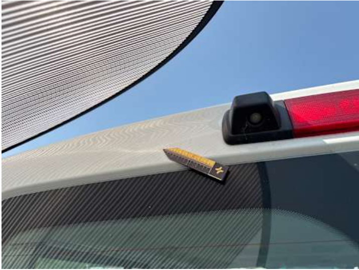
Heckklappe (Lackschaden, Rost, Delle)
