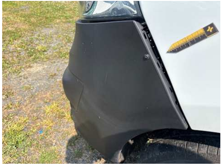
Stoßstange vorne (Riss/Bruch, Spaltmaße ungenau)
