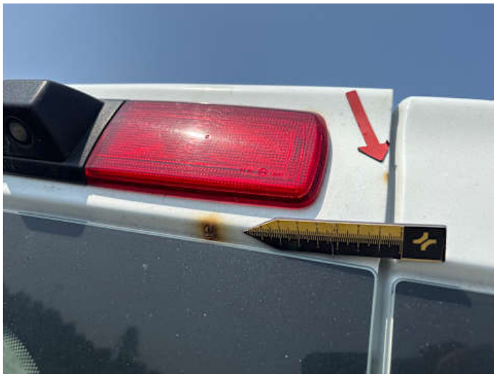
Heckklappe (Lackschaden, Rost, Delle)
