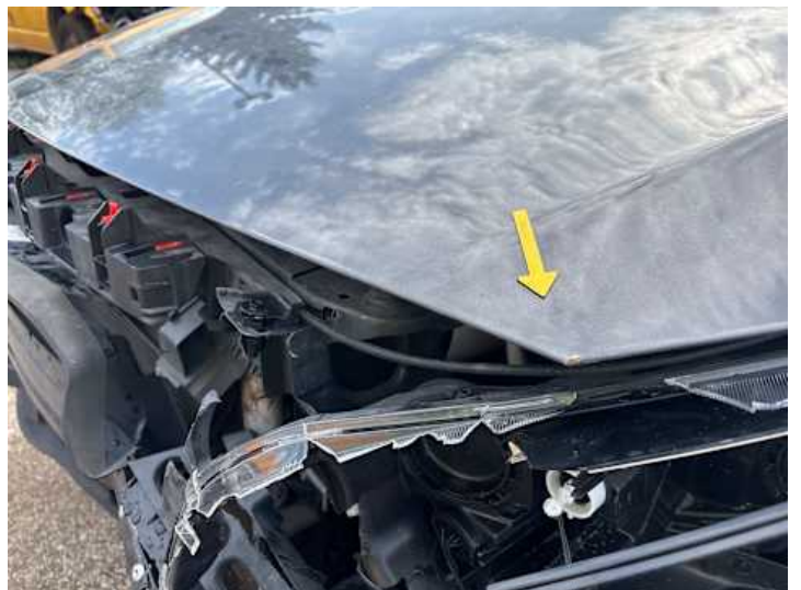
Motorhaube (Kratzer, Lackschaden, Rost)
