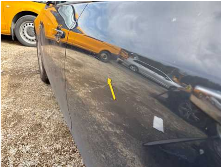
Türe hinten links (Kratzer)
