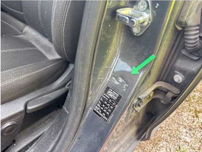
Schweller links (Kratzer, Delle)
