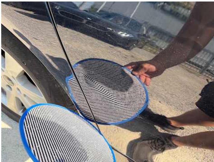
Türe hinten rechts (Kratzer, Lackschaden, Delle)
