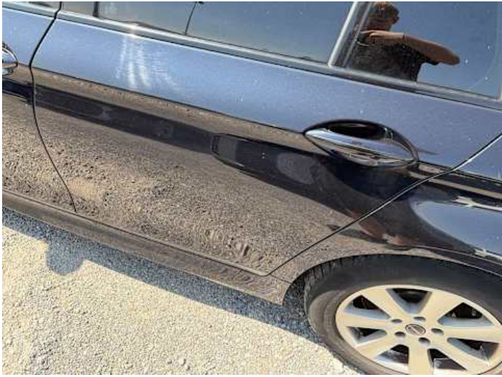
Türe hinten links (Kratzer, Lackschaden)
