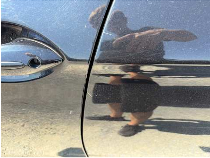
Türe hinten links (Kratzer, Lackschaden)
