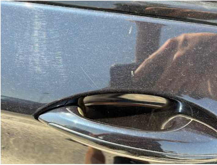
Türe hinten links (Kratzer, Lackschaden)
