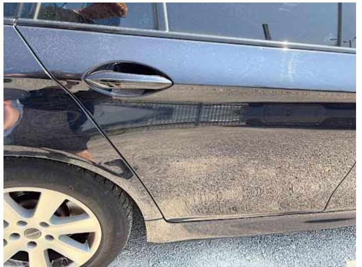
Türe hinten rechts (Kratzer, Lackschaden, Delle)
