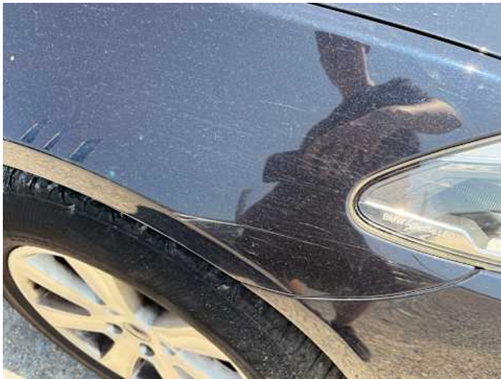
Kotflügel vorne rechts (Kratzer, Lackschaden)
