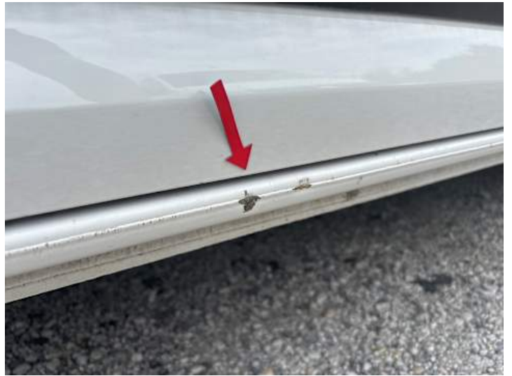
Schweller rechts (Lackschaden, Kratzer)
