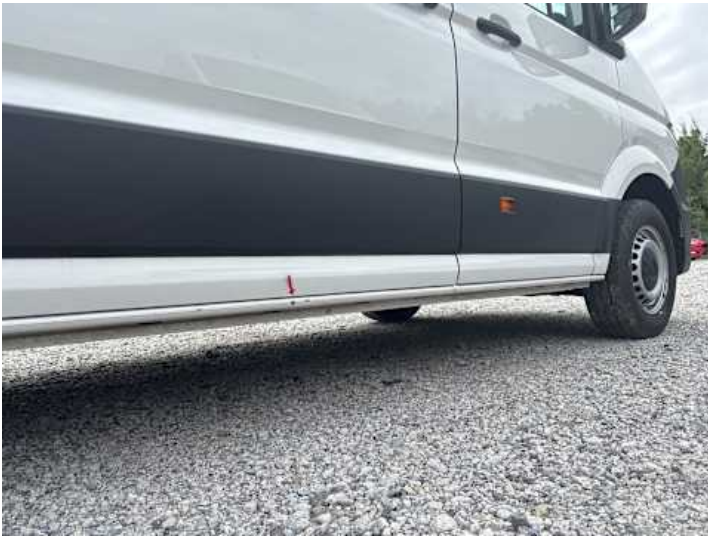
Schweller rechts (Lackschaden, Kratzer)
