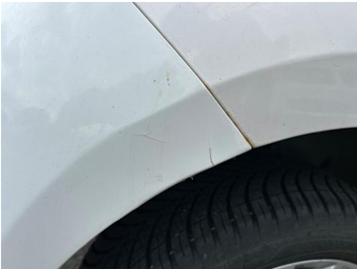
Stoßstange hinten (Riss/Bruch)
