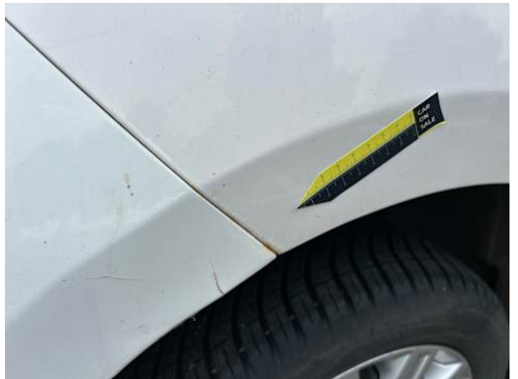
Seitenteil hinten rechts (Rost)
