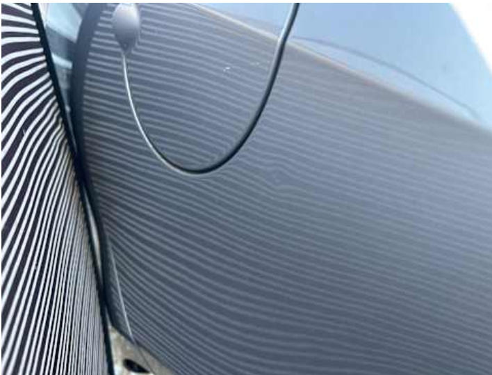
Seitenteil hinten rechts (Delle)
