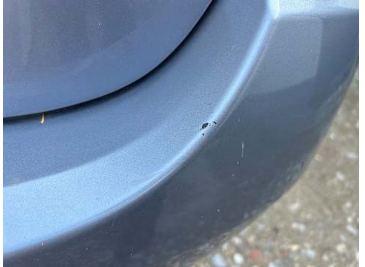
Stoßstange hinten (Lackschaden)
