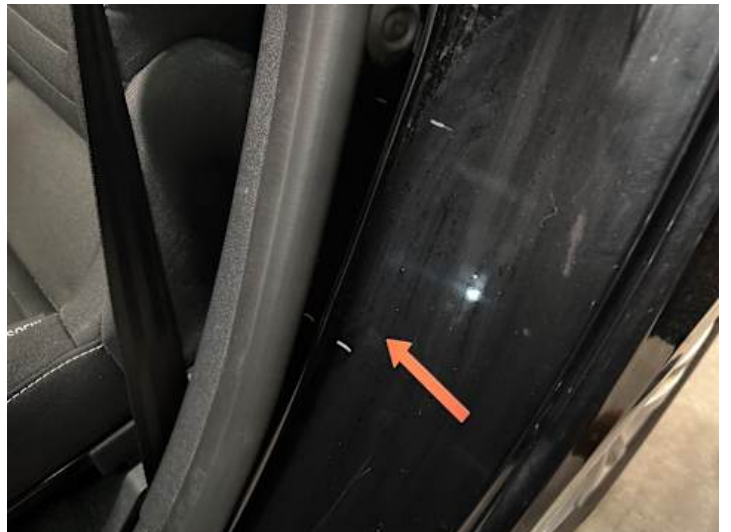
Schweller links (Lackschaden)
