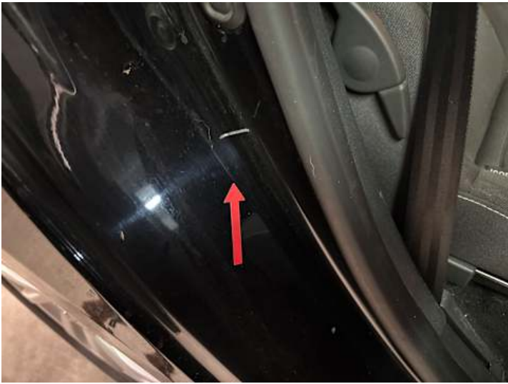
Schweller rechts (Lackschaden)
