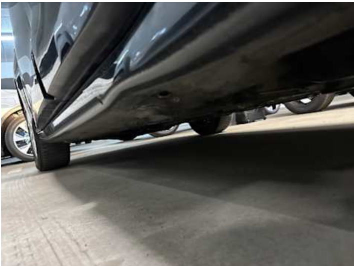
Schweller links (Verformung)
