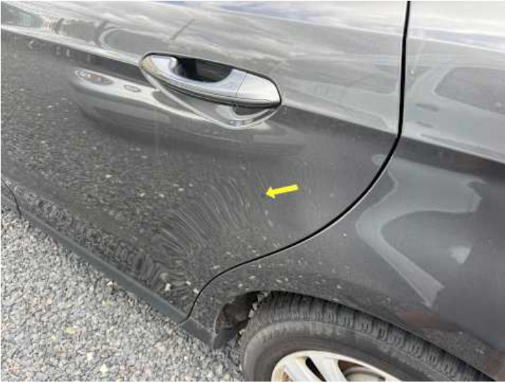
Türe hinten links (Lackschaden, Unsachgemäß instand gesetzt)
