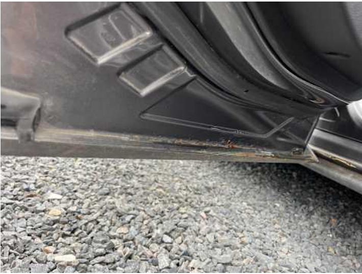
Türe hinten links (Rost)
