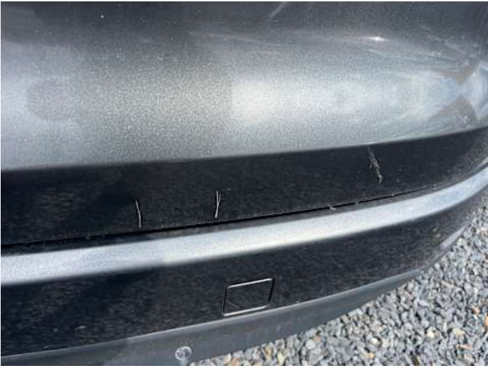
Heckklappe (Lackschaden, Kratzer)
