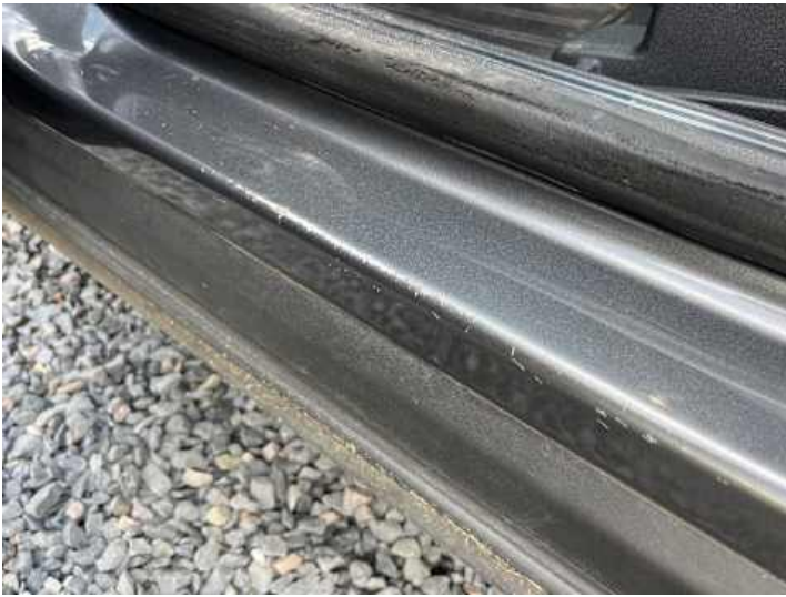
Schweller links (Lackschaden, Kratzer)
