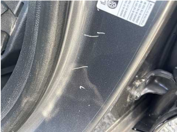
Schweller links (Lackschaden, Kratzer)
