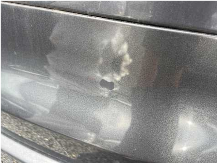
Heckklappe (Lackschaden, Kratzer)
