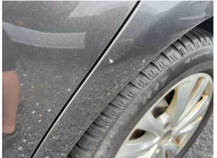
Seitenteil hinten links (Lackschaden, Kratzer)
