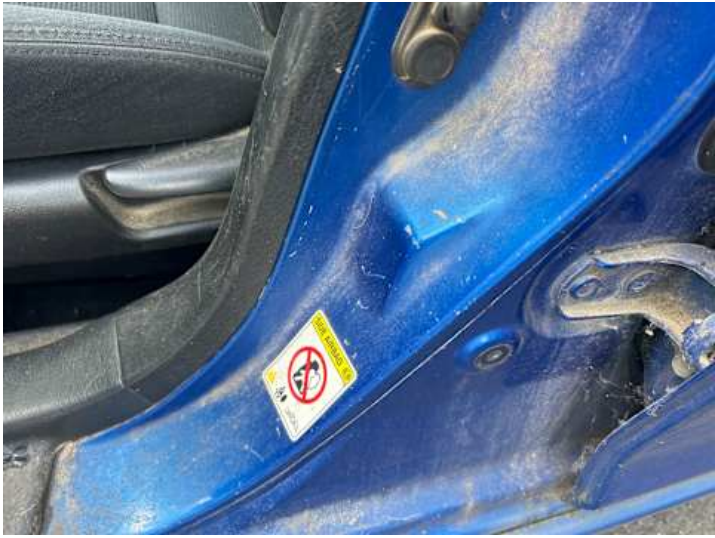
Schweller links (Kratzer, Delle)
