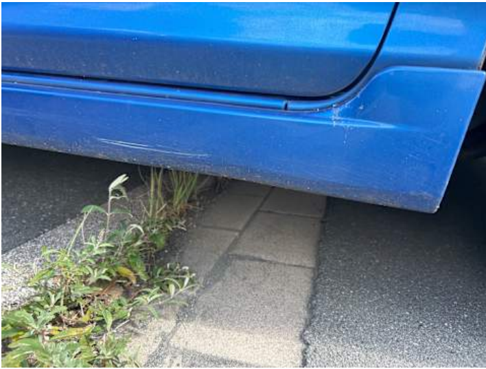
Schweller rechts (Kratzer)
