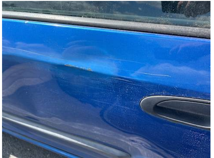
Türe hinten links (Ausgeblichen/Matt, Rost, Verformung)
