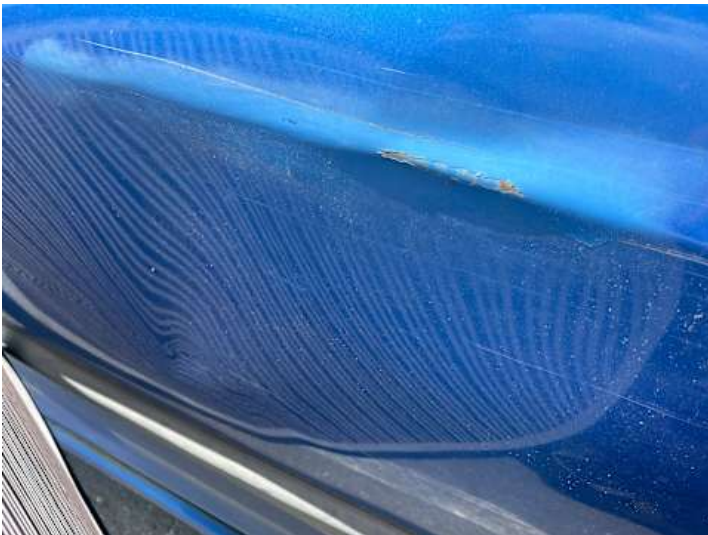
Türe hinten links (Ausgeblichen/Matt, Rost, Verformung)
