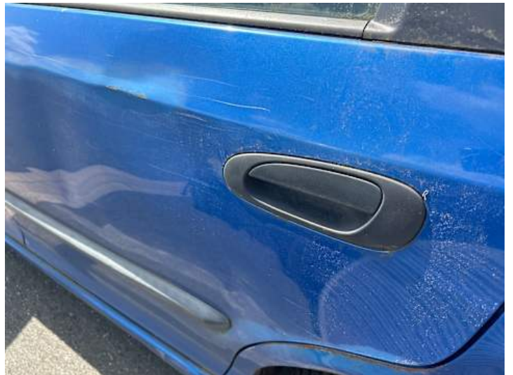
Türe hinten links (Ausgeblichen/Matt, Rost, Verformung)
