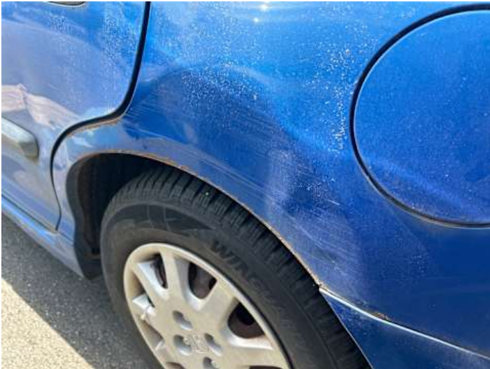
Seitenteil hinten links (Kratzer, Verformung, Rost)
