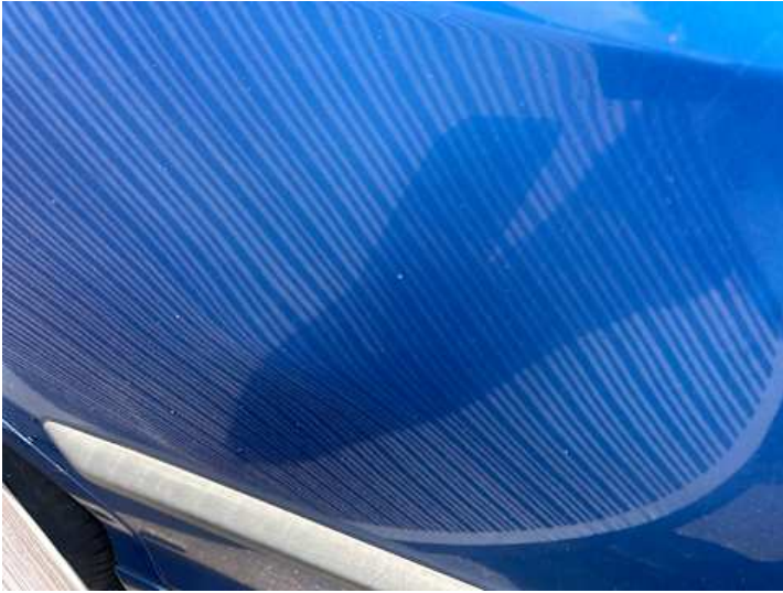
Türe hinten rechts (Verformung)
