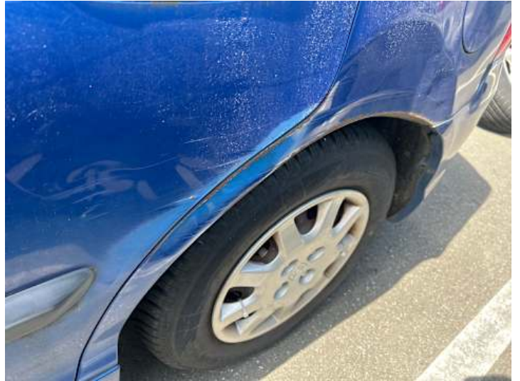
Seitenteil hinten links (Kratzer, Verformung, Rost)
