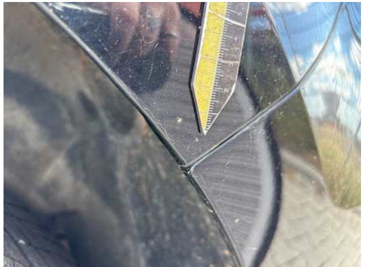
Seitenteil hinten links (Rost, Lackschaden)
