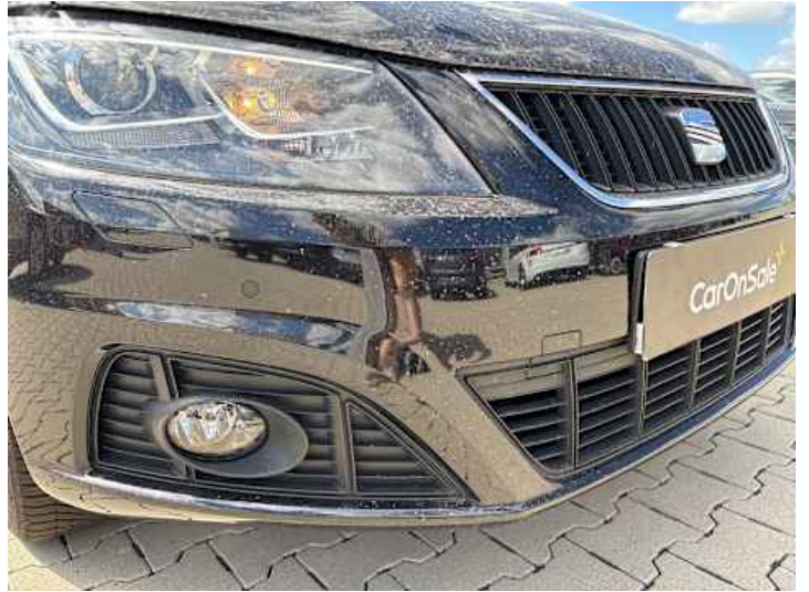
Stoßstange vorne (Anderer Schaden): Farbspritzer, schwer zu entfernen
