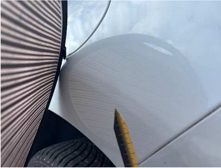
Seitenteil hinten links (Delle, Verformung)
