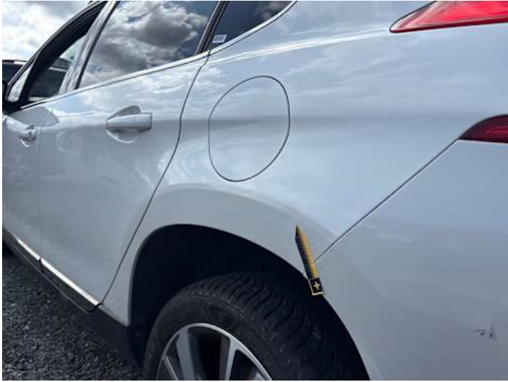
Seitenteil hinten links (Delle, Verformung)
