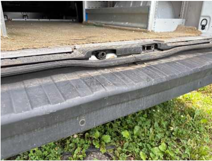
Stoßstange hinten (Verformung, Kratzer)
