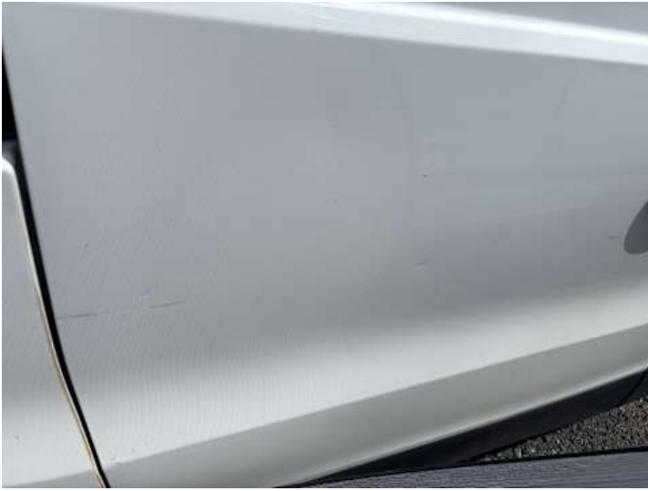
Türe hinten rechts (Kratzer, Delle)
