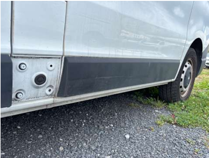
Seitenteil hinten links (Anderer Schaden): Verkleidung fehlt
