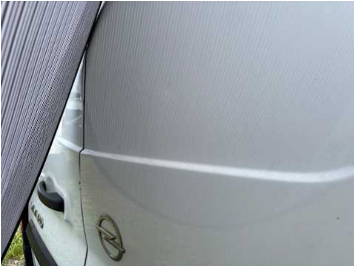
Heckklappe (Kratzer, Delle)
