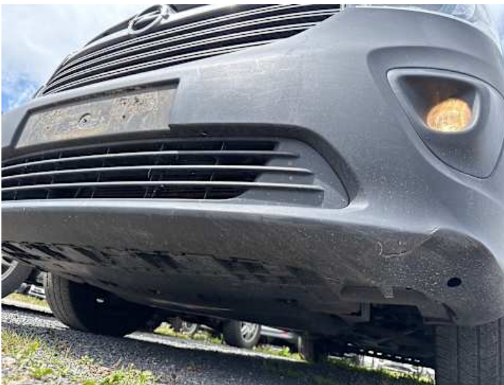
Stoßstange vorne (Kratzer, Verformung)
