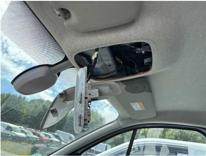
Innenraum (Diverse Schäden, Riss/Bruch)
