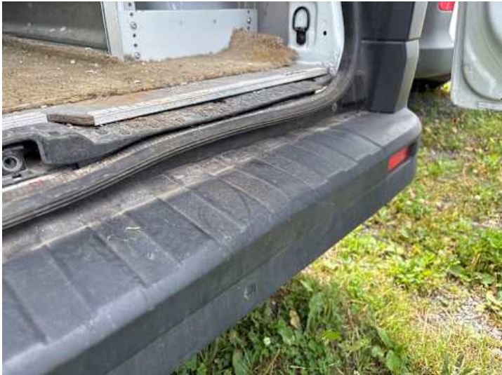
Stoßstange hinten (Verformung, Kratzer)
