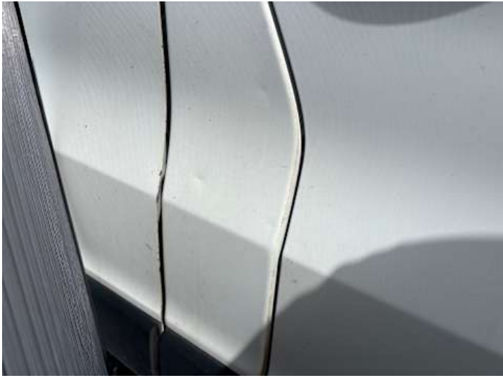
Türe hinten rechts (Kratzer, Delle)
