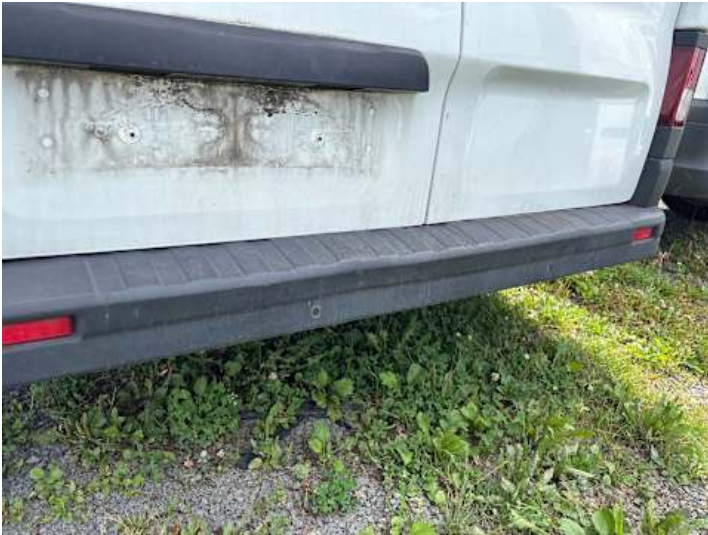
Stoßstange hinten (Verformung, Kratzer)
