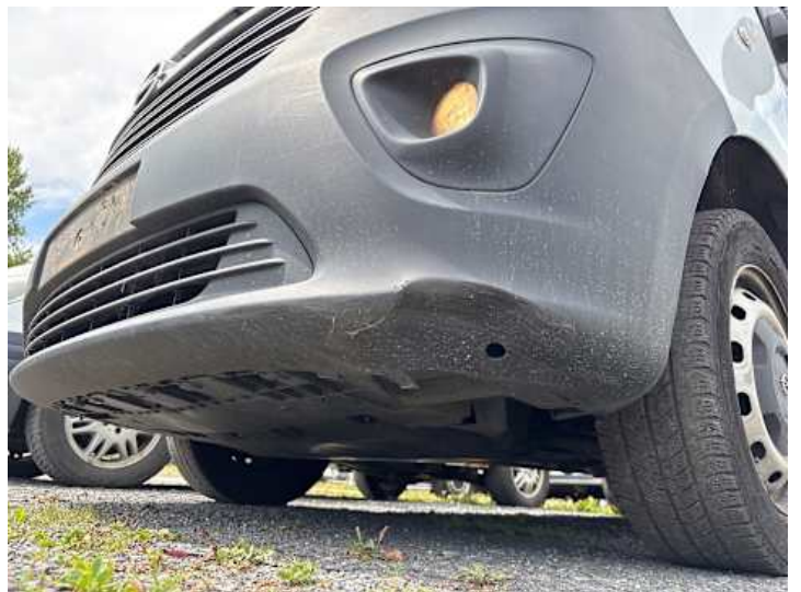
Stoßstange vorne (Kratzer, Verformung)
