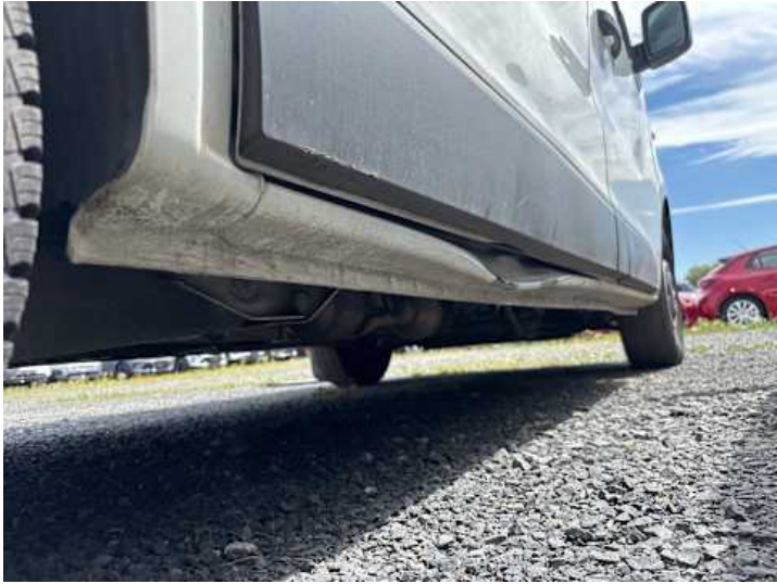
Schweller rechts (Verformung, Lackschaden)
