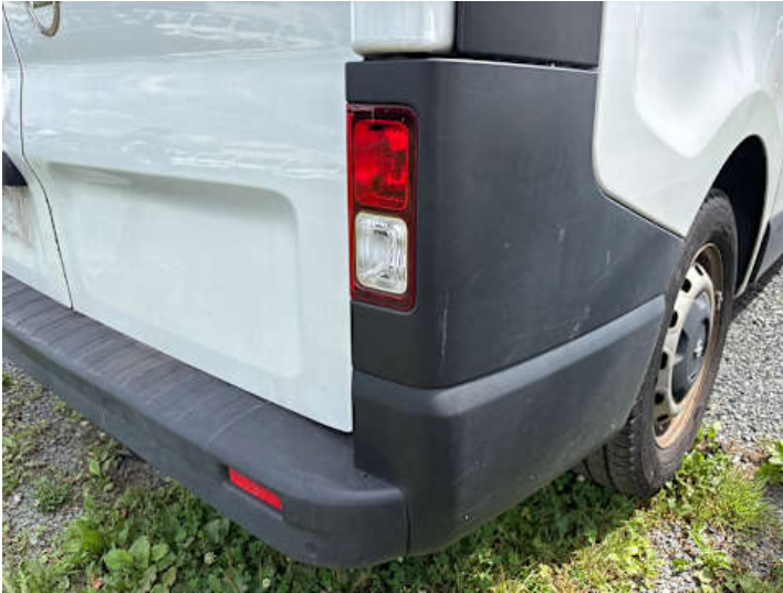
Stoßstange hinten (Verformung, Kratzer)
