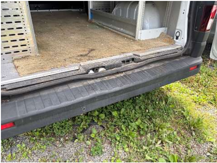
Stoßstange hinten (Verformung, Kratzer)
