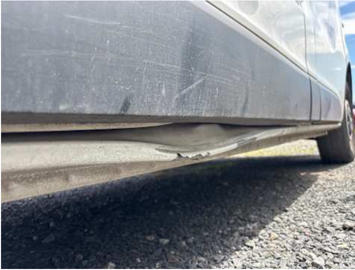
Schweller rechts (Verformung, Lackschaden)
