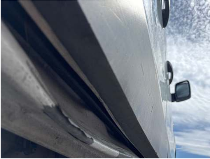
Türe hinten rechts (Verformung, Kratzer)
