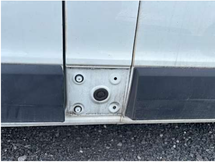
Seitenteil hinten links (Anderer Schaden): Verkleidung fehlt
