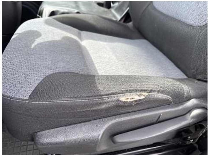
Innenraum (Verschleiß, Riss/Bruch)
