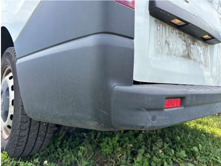
Stoßstange hinten (Verformung, Kratzer)
