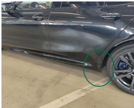
Schwellerabdeckung / Links / Kratzer
