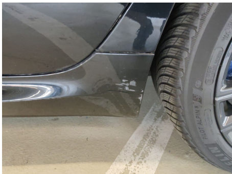
Schwellerabdeckung / Links / Kratzer
