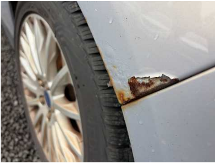
Seitenteil hinten links (Lackschaden, Rost)
