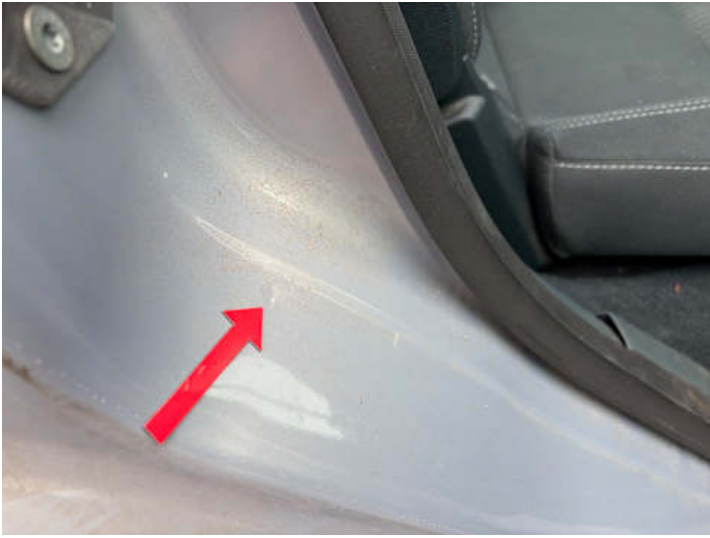
Schweller rechts (Lackschaden, Delle, Rost)
