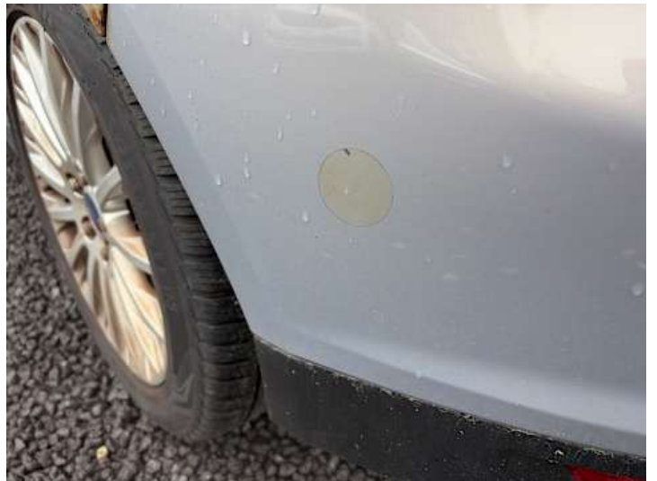
Stoßstange hinten (Anderer Schaden): Kleberest
