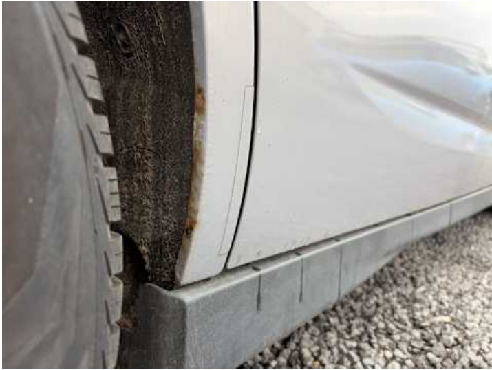
Schweller rechts (Lackschaden, Delle, Rost)
