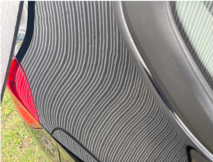
Seitenteil hinten rechts (Unsachgemäß instand gesetzt)
