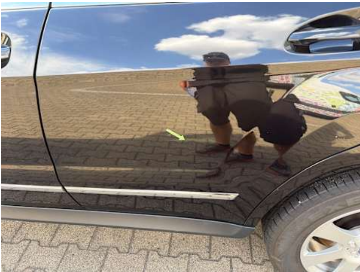
Türe hinten links (Delle)
