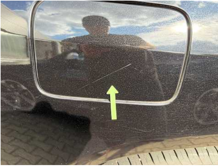
Seitenteil hinten rechts (Kratzer)
