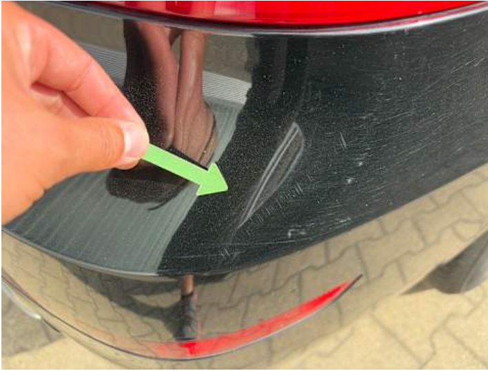
Stoßstange hinten (Kratzer)
