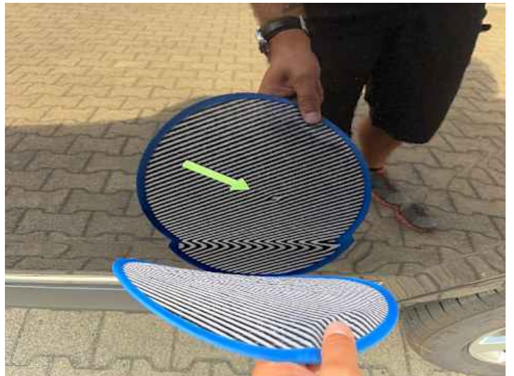
Türe hinten links (Delle)
