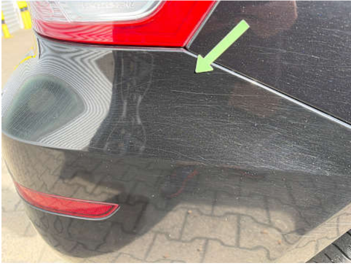
Stoßstange hinten (Kratzer)
