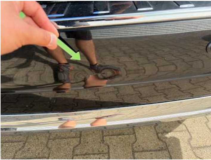
Stoßstange hinten (Riss/Bruch)
