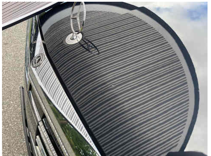
Motorhaube (Lackschaden, Delle)
