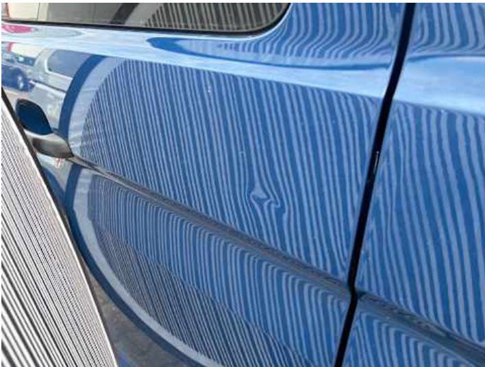
Türe hinten rechts (Delle)
