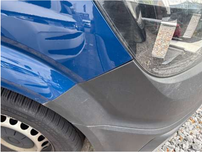
Stoßstange vorne (Spaltmaße ungenau)
