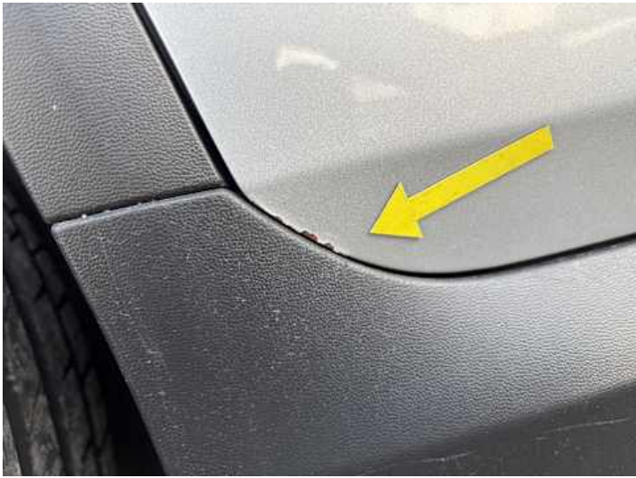
Türe hinten rechts (Rost)
