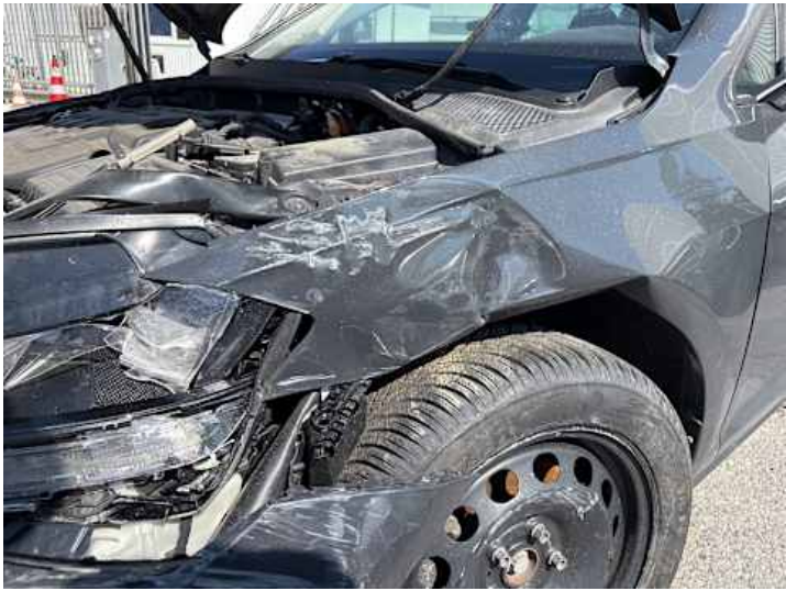
Kotflügel vorne links (Verformung, Lackschaden)
