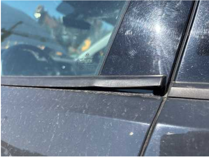
Fahrtür (Spaltmaße ungenau)
