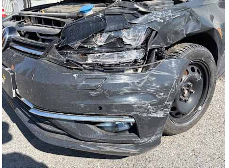
Stoßstange vorne (Riss/Bruch, Verformung, Lackschaden)
