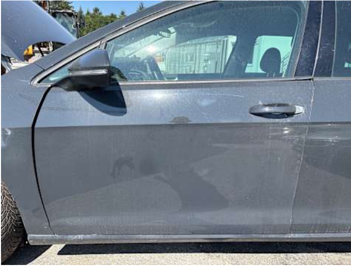
Fahrtür (Spaltmaße ungenau)
