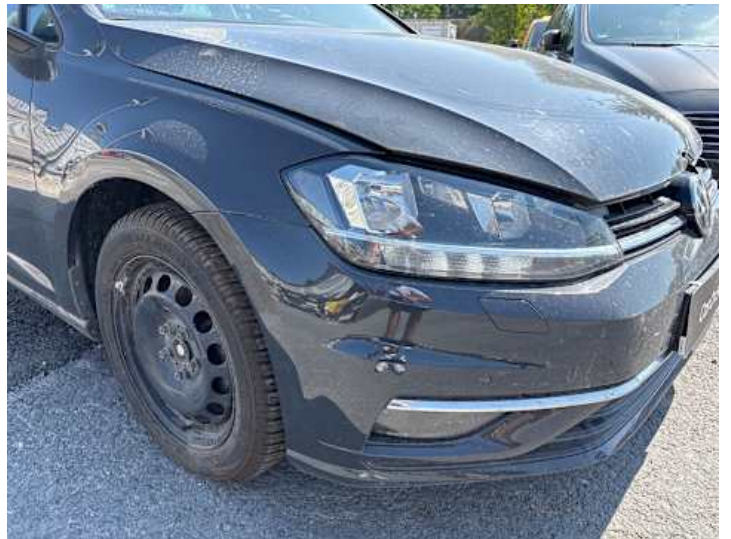
Motorhaube (Verformung, Lackschaden, Spaltmaße ungenau)
