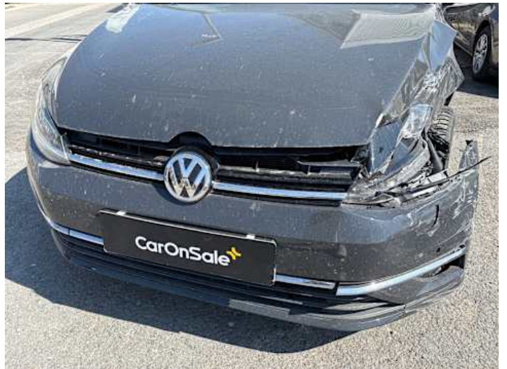
Motorhaube (Verformung, Lackschaden, Spaltmaße ungenau)
