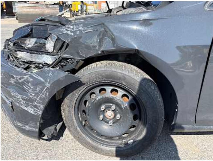
Kotflügel vorne links (Verformung, Lackschaden)
