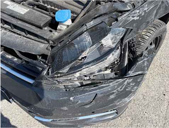
Stoßstange vorne (Riss/Bruch, Verformung, Lackschaden)
