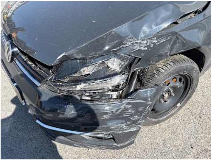
Motorhaube (Verformung, Lackschaden, Spaltmaße ungenau)
