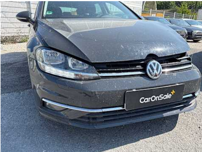
Motorhaube (Verformung, Lackschaden, Spaltmaße ungenau)
