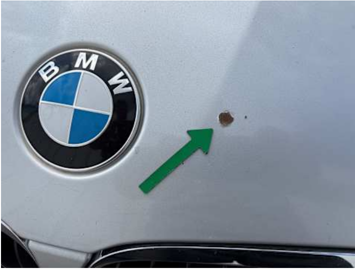
Motorhaube (Lackschaden, Rost)
