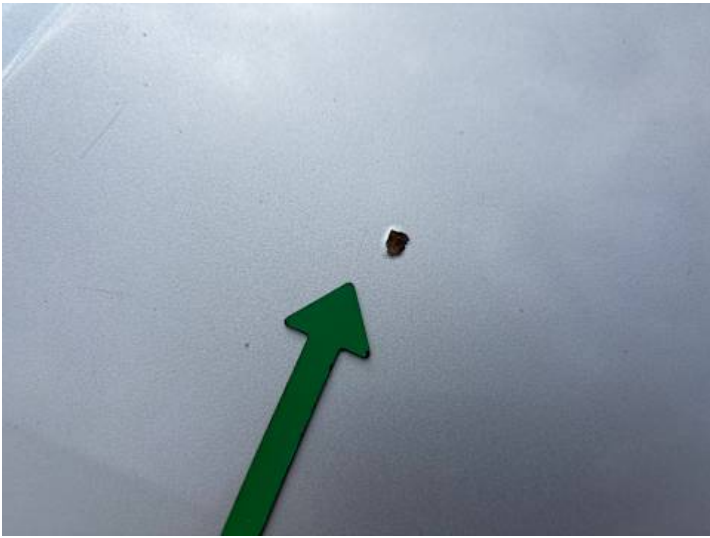
Motorhaube (Lackschaden, Rost)
