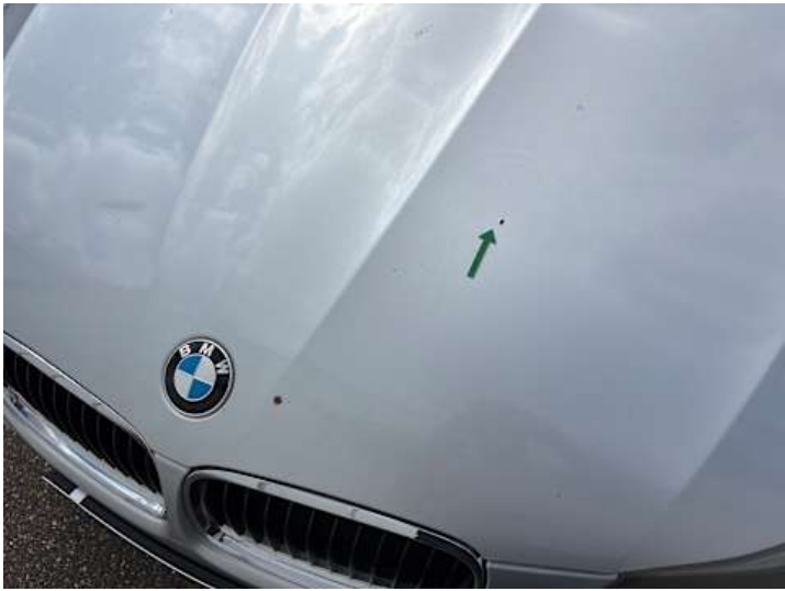
Motorhaube (Lackschaden, Rost)
