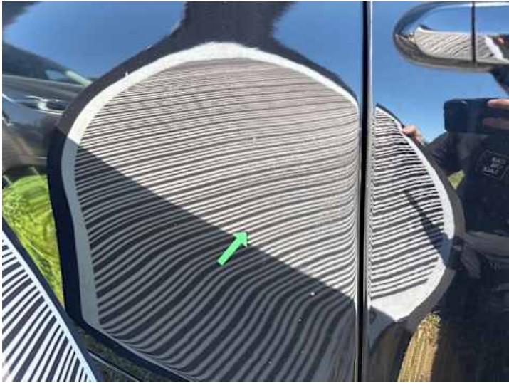
Türe hinten rechts (Lackschaden, Unsachgemäß instand gesetzt, Ausgeblichen/Matt)
