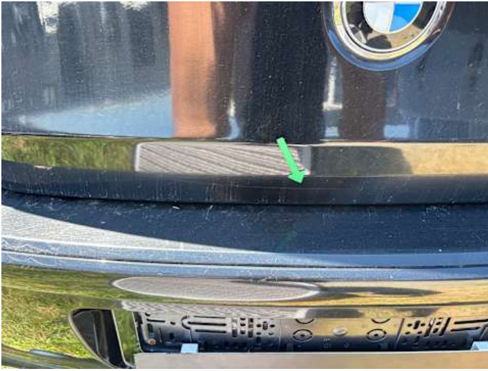
Heckklappe (Lackschaden, Rost, Kratzer)
