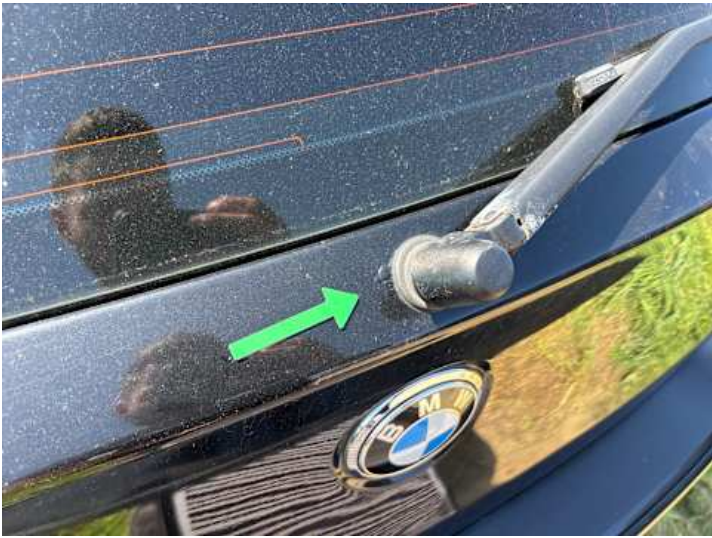
Heckklappe (Lackschaden, Rost, Kratzer)
