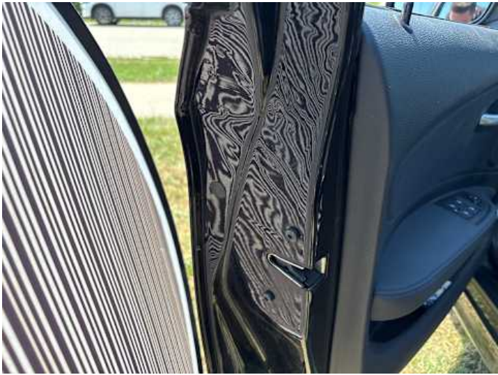
Fahrertür (Delle, Verformung)
