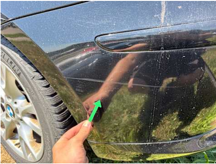
Stoßstange hinten (Kratzer, Lackschaden)
