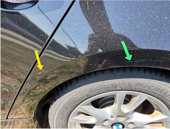
Seitenteil hinten links (Kratzer, Lackschaden, Delle)
