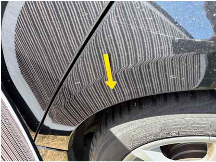
Seitenteil hinten links (Kratzer, Lackschaden, Delle)
