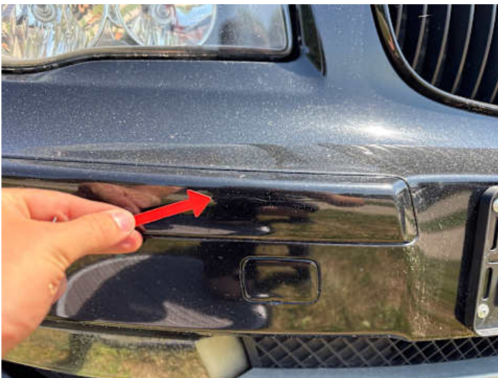
Stoßstange vorne (Kratzer, Lackschaden)
