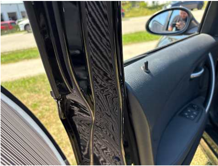
Fahrertür (Delle, Verformung)
