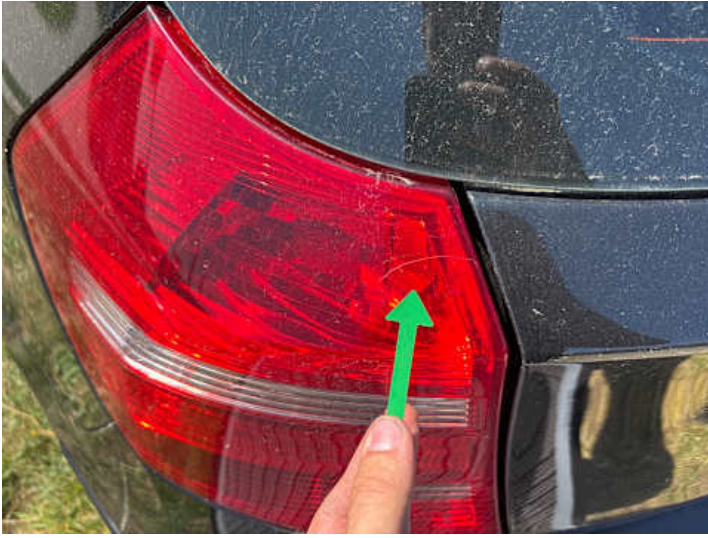
Rücklicht (links) (Riss/Bruch)
