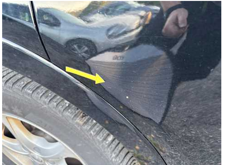
Türe hinten rechts (Steinschlag)
