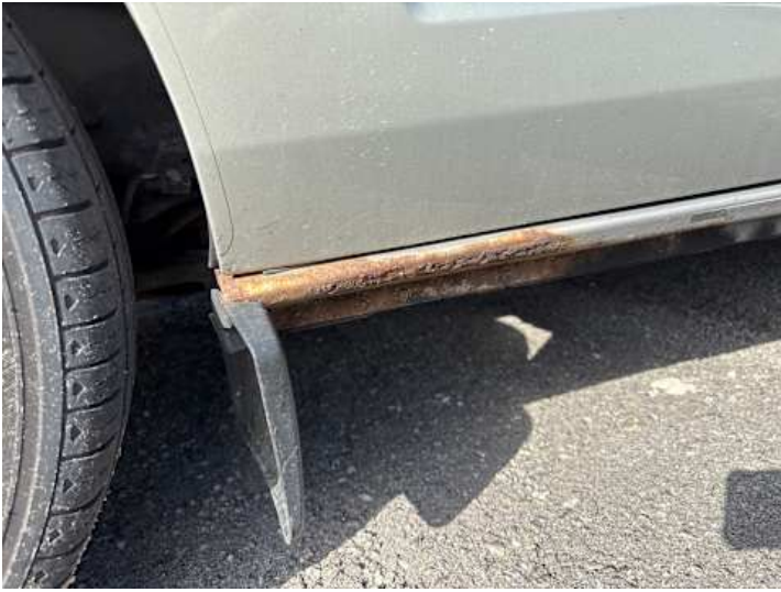
Schweller links (Rost)
