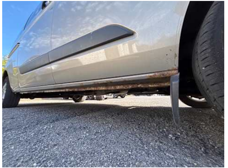
Schweller rechts (Rost, Verformung)
