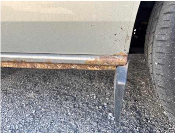
Schweller rechts (Rost, Verformung)
