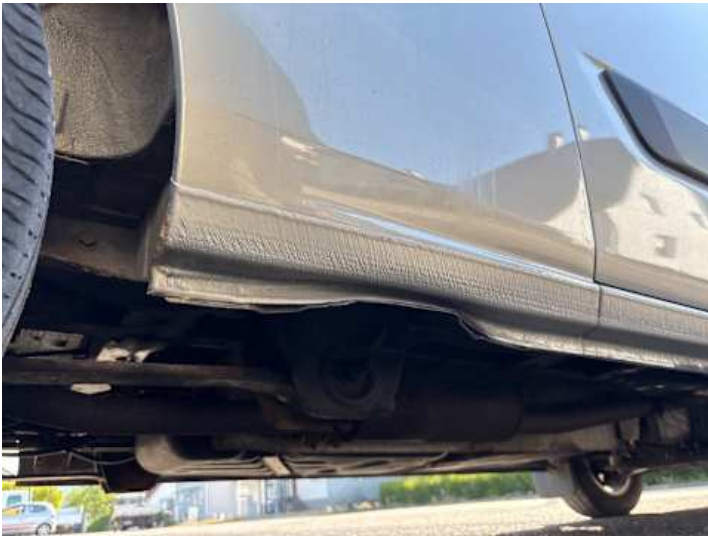
Schweller rechts (Rost, Verformung)
