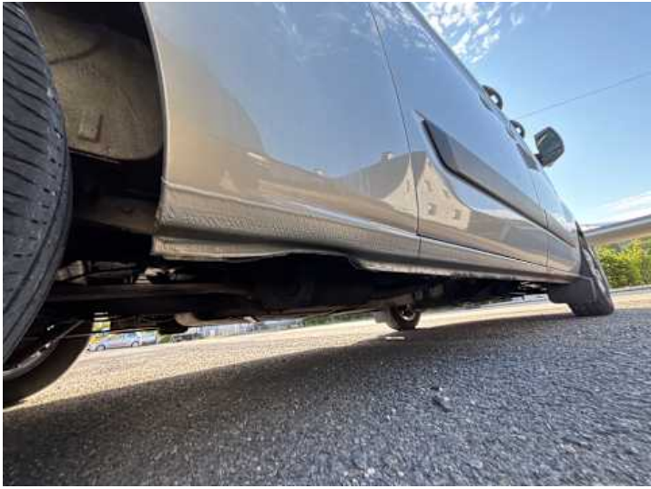
Schweller rechts (Rost, Verformung)
