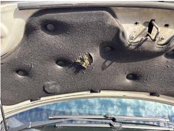
Motorhaube (Anderer Schaden): Marderspuren
