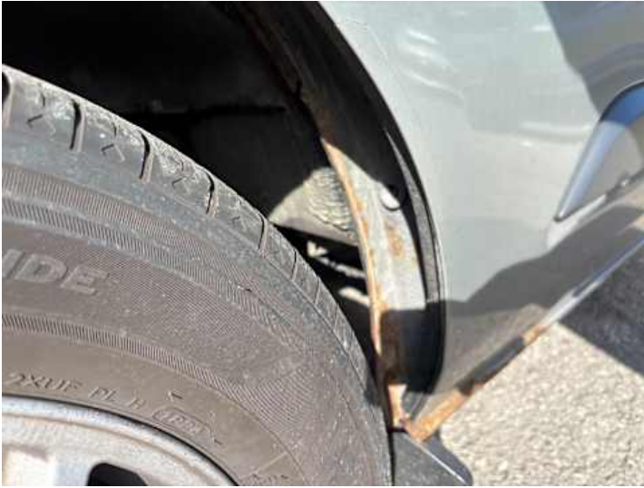
Schweller links (Rost)
