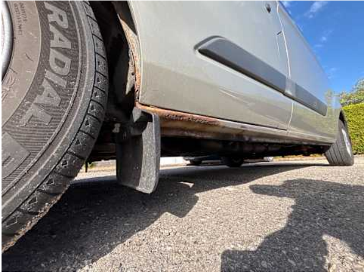
Schweller links (Rost)
