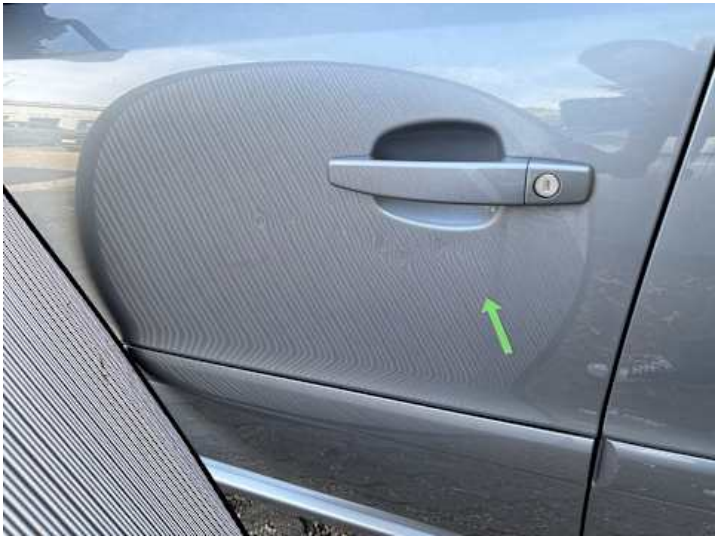
Fahrentür (Kratzer, Delle)
