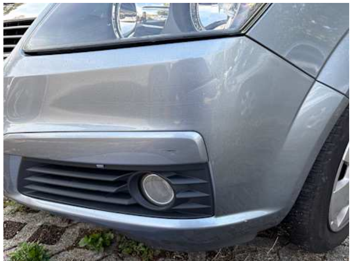
Stoßstange vorne (Verformung, Lackschaden)
