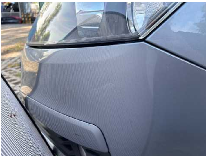
Stoßstange vorne (Verformung, Lackschaden)
