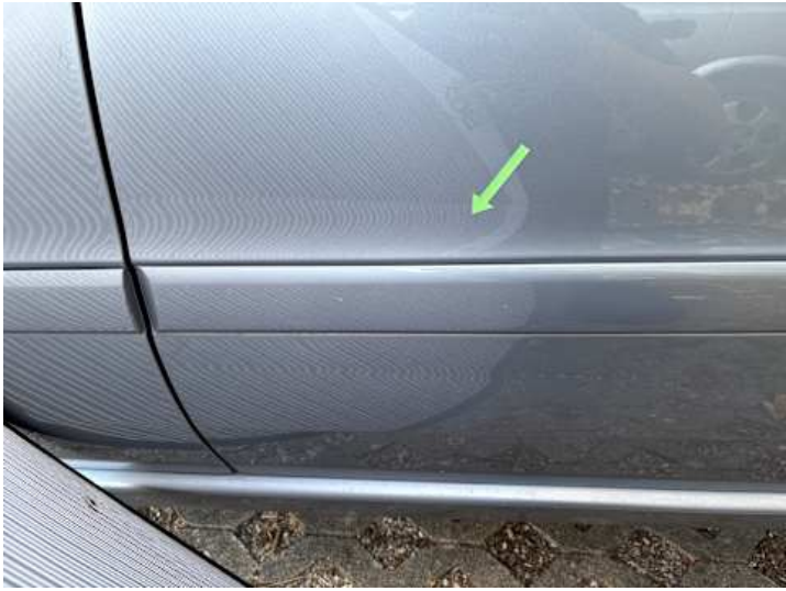
Türe hinten links (Kratzer, Delle)
