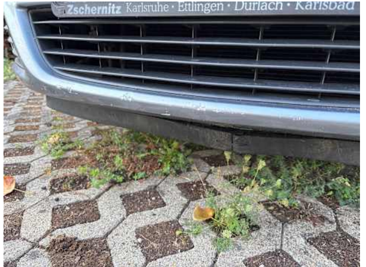
Stoßstange vorne (Verformung, Lackschaden)
