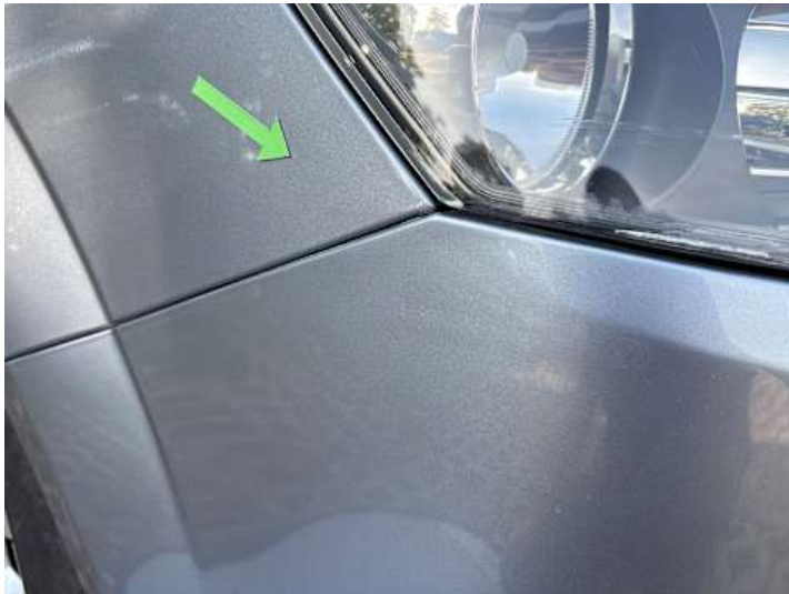
Stoßstange vorne (Verformung, Lackschaden)
