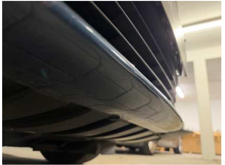
Stoßstange vorne (Kratzer, Steinschlag)
