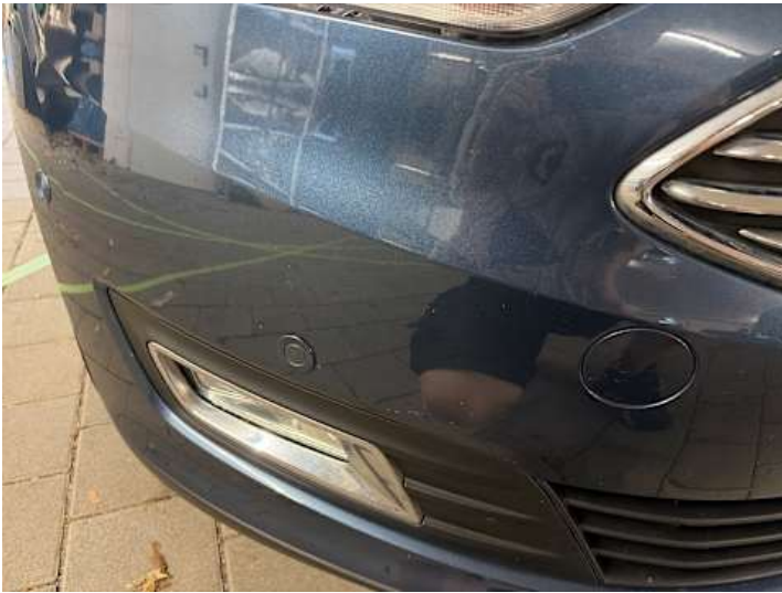
Stoßstange vorne (Kratzer, Steinschlag)
