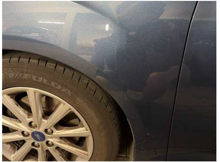
Kotflügel vorne links (Kratzer, Lackschaden)
