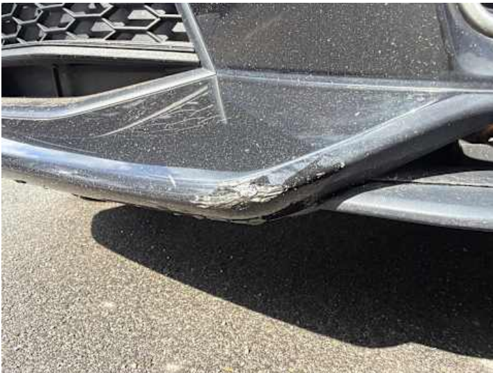
Stoßstange vorne (Verformung, Lackschaden)
