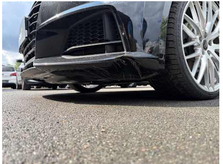
Stoßstange vorne (Verformung, Lackschaden)
