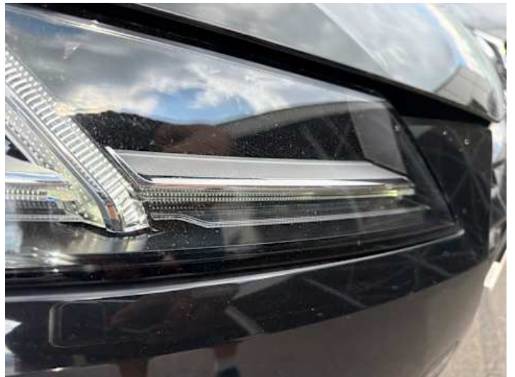
Scheinwerfer (rechts) (Steinschlag)
