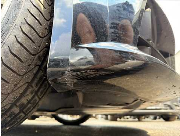
Stoßstange vorne (Verformung, Lackschaden)
