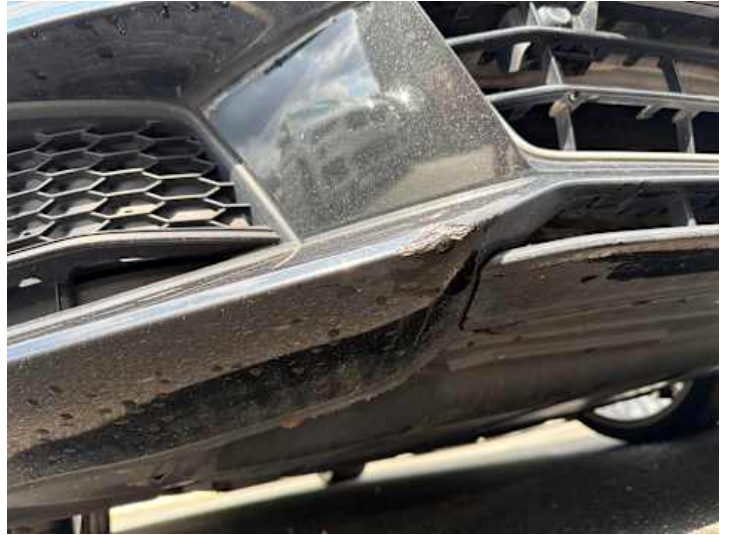
Stoßstange vorne (Verformung, Lackschaden)
