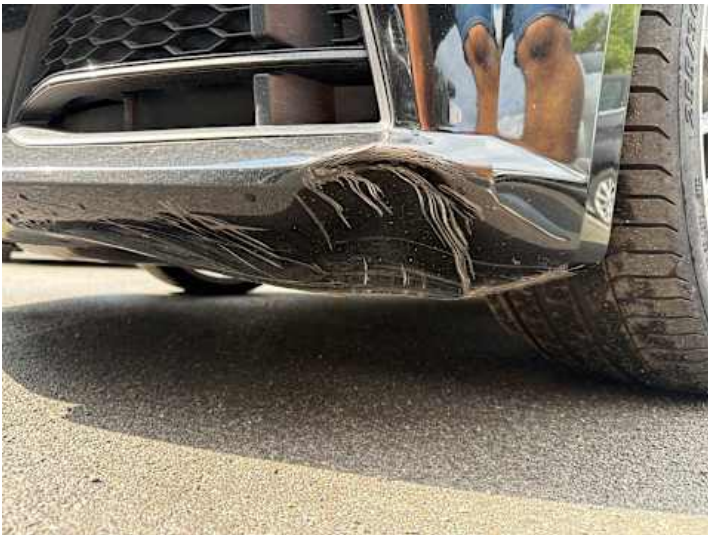
Stoßstange vorne (Verformung, Lackschaden)
