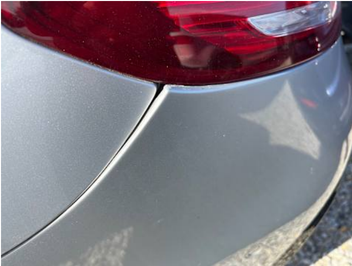
Stoßstange hinten (Spaltmaße ungenau, Unsachgemäß instand gesetzt)
