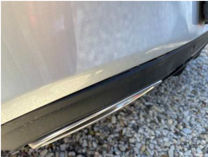
Stoßstange hinten (Spaltmaße ungenau, Unsachgemäß instand gesetzt)
