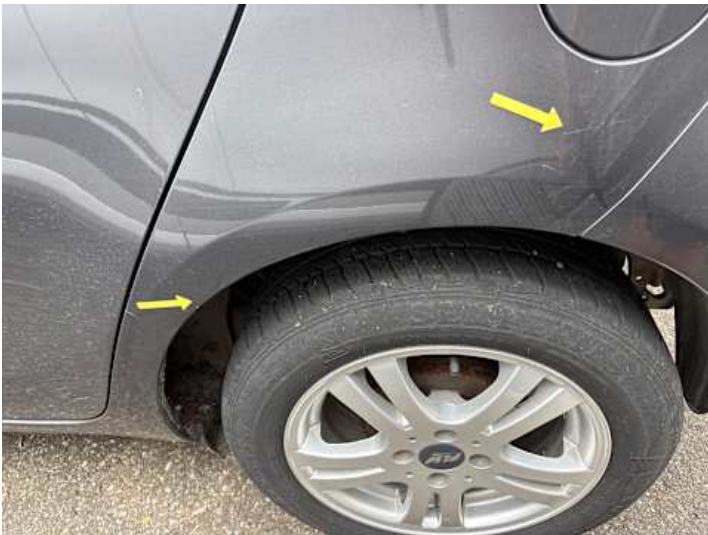
Seitenteil hinten links (Kratzer)
