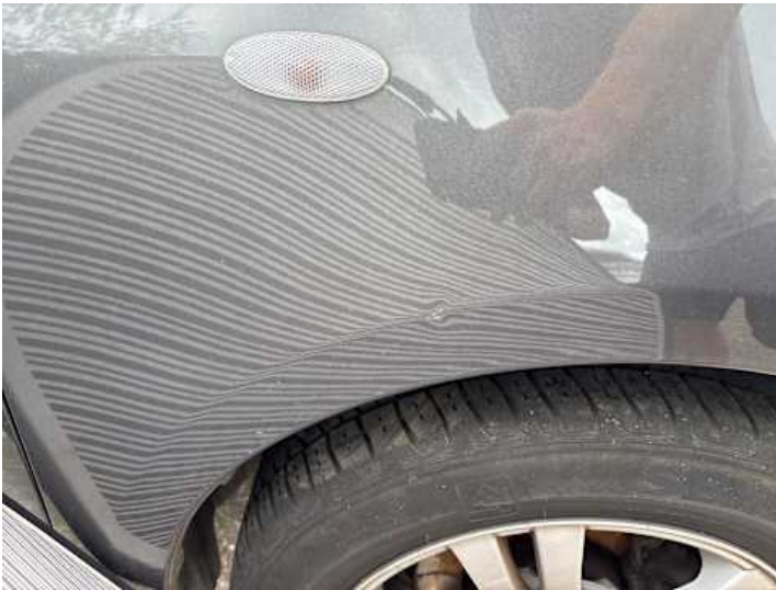
Kotflügel vorne rechts (Delle, Kratzer)
