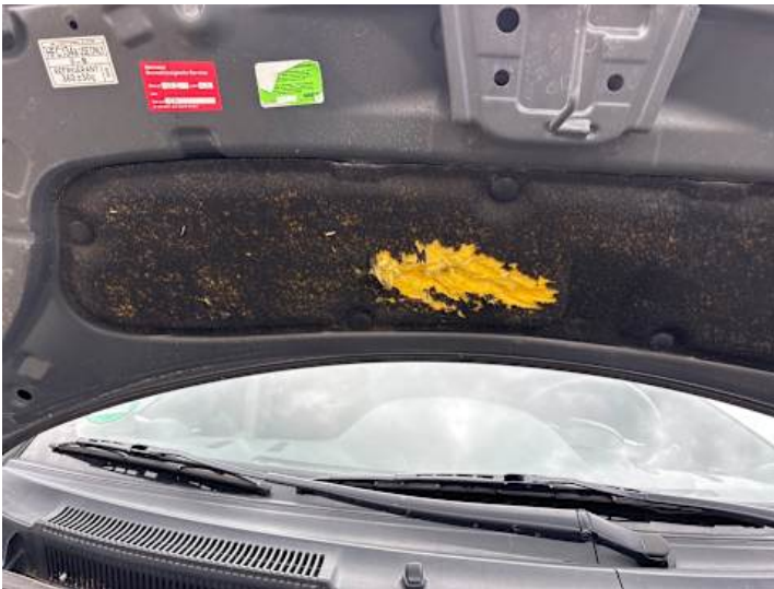
Motorhaube (Anderer Schaden): Dämmmatte angefressen
