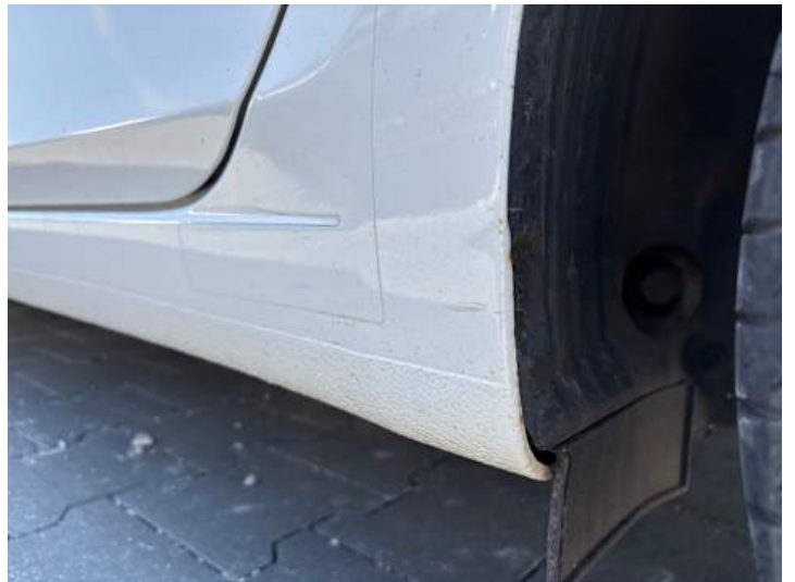
Seitenteil hinten links (Rost)
