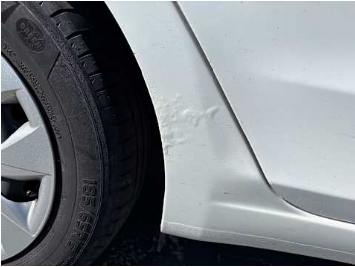
Seitenteil hinten rechts (Rost, Lackschaden)
