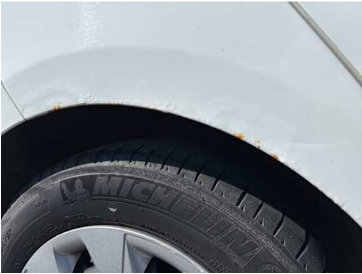
Seitenteil hinten rechts (Rost, Lackschaden)
