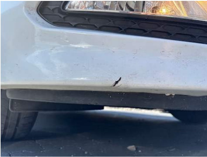
Stoßstange vorne (Riss/Bruch)
