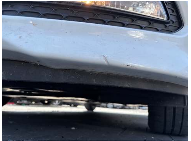
Stoßstange vorne (Riss/Bruch)
