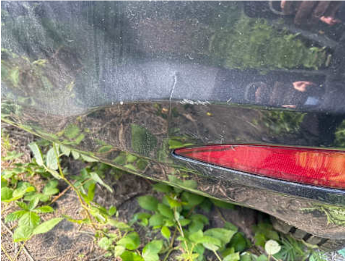
Stoßstange hinten (Kratzer, Riss/Bruch)
