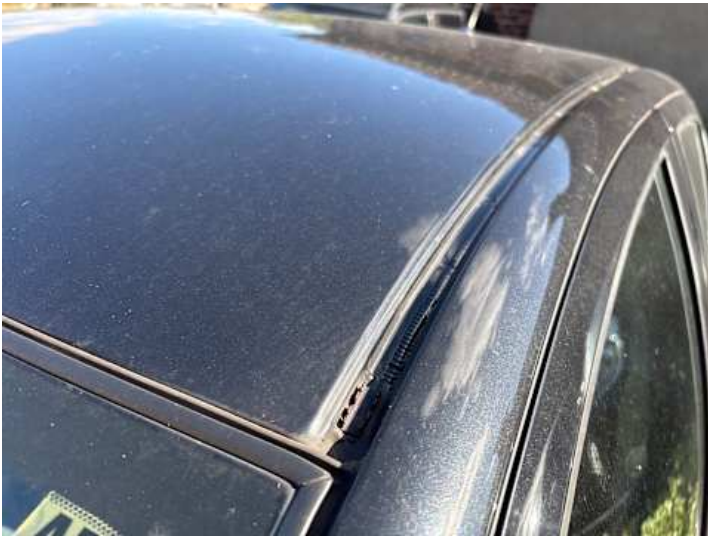
Dach (Anderer Schaden): Zierleiste fehlt
