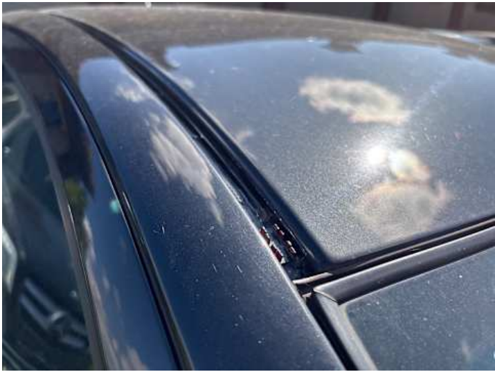
Dach (Anderer Schaden): Zierleiste fehlt
