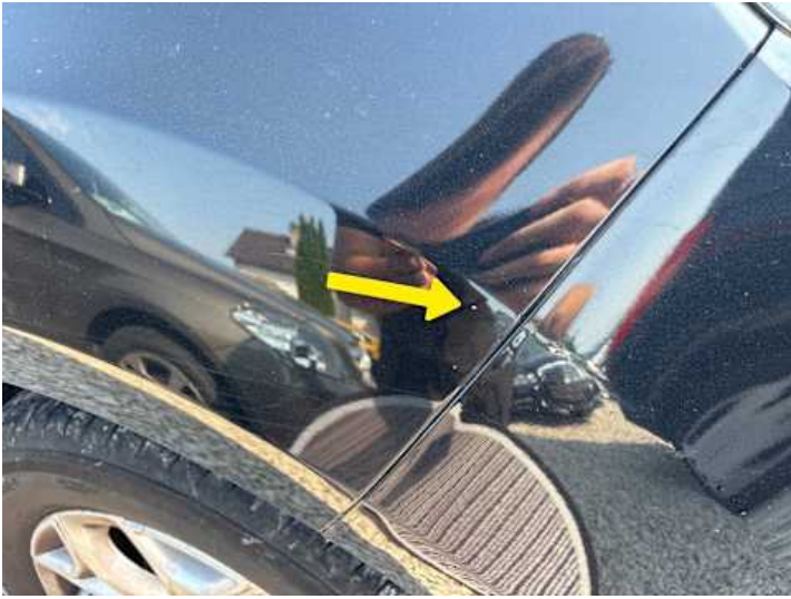
Kotflügel vorne rechts (Steinschlag)
