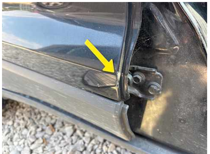
Türe hinten rechts (Lackschaden)
