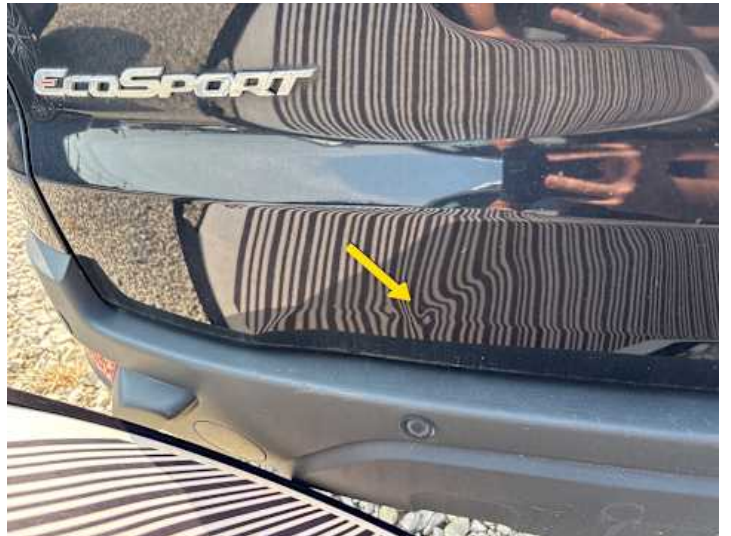
Heckklappe (Delle, Verformung)
