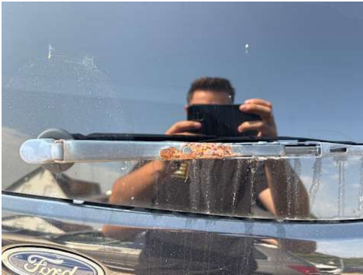
Rückscheibe (Anderer Schaden): Heckscheibenwischer Korrosion
