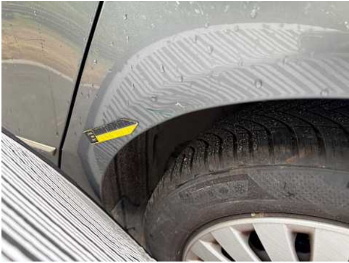
Seitenteil hinten links (Verformung, Delle, Kratzer)
