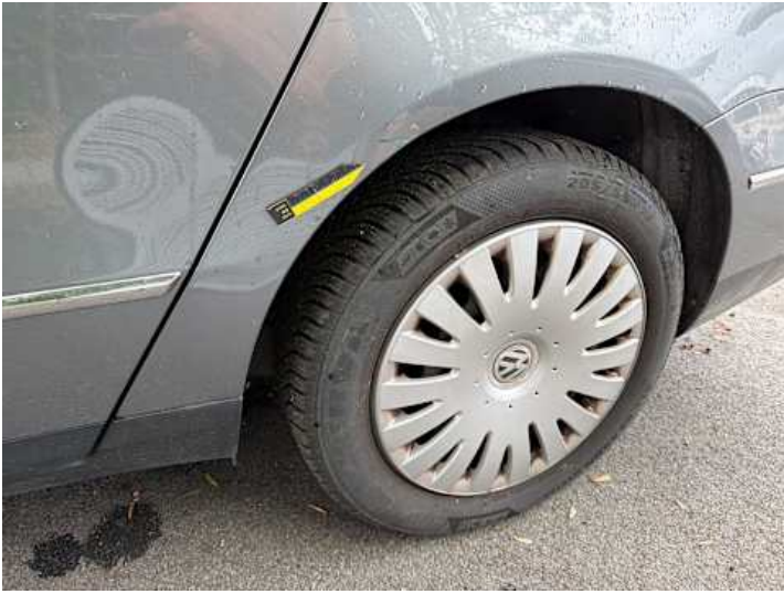
Seitenteil hinten links (Verformung, Delle, Kratzer)
