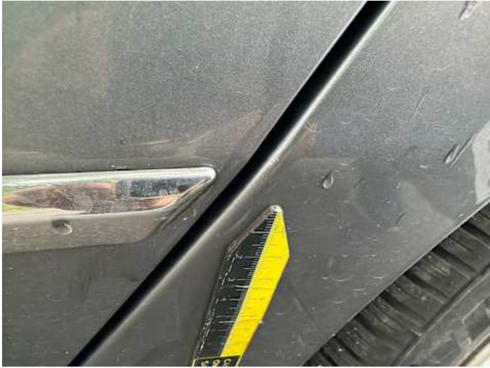
Seitenteil hinten links (Verformung, Delle, Kratzer)
