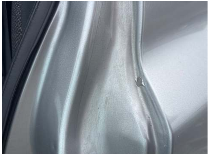
Seitenteil hinten links (Kratzer)
