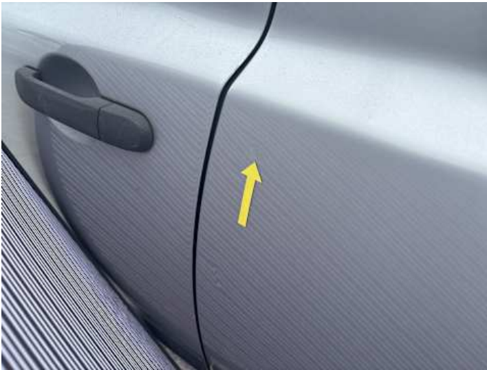
Türe hinten links (Delle)
