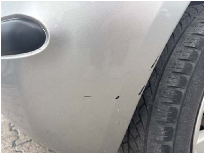
Stoßstange hinten (Kratzer, Lackschaden, Verformung)
