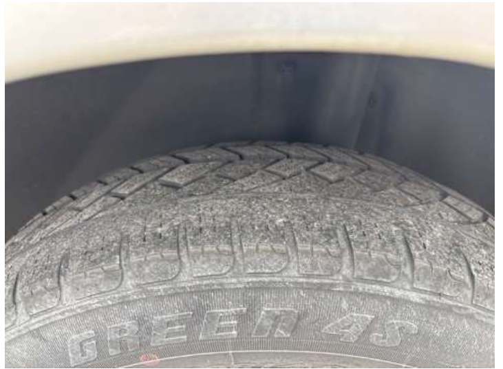
Rad (Ungleichmäßig abgefahren)
