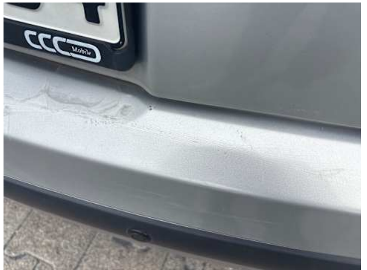
Stoßstange hinten (Kratzer, Lackschaden, Verformung)
