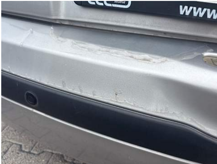
Stoßstange hinten (Kratzer, Lackschaden, Verformung)
