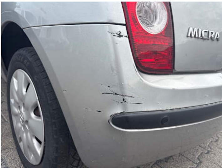
Stoßstange hinten (Kratzer, Lackschaden, Verformung)
