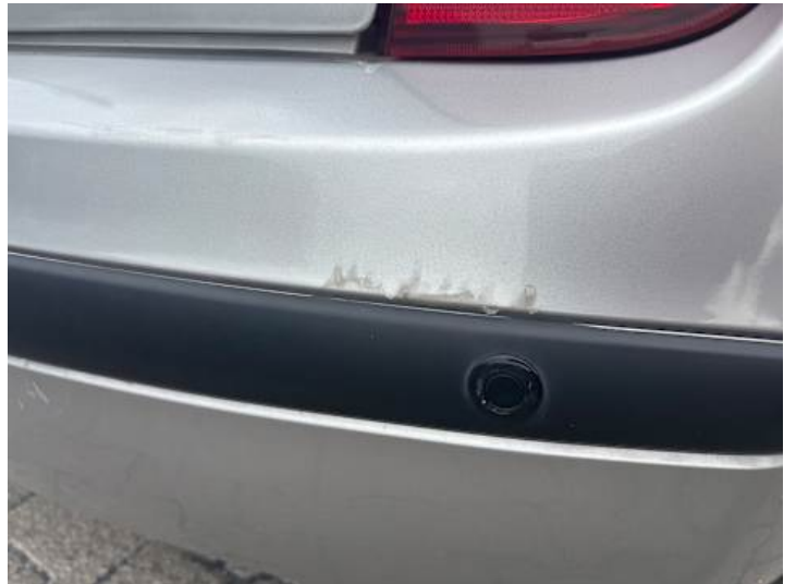
Stoßstange hinten (Kratzer, Lackschaden, Verformung)
