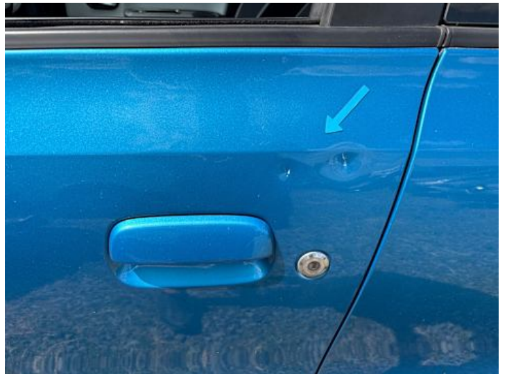
Fahrtür (Delle, Lackschaden)
