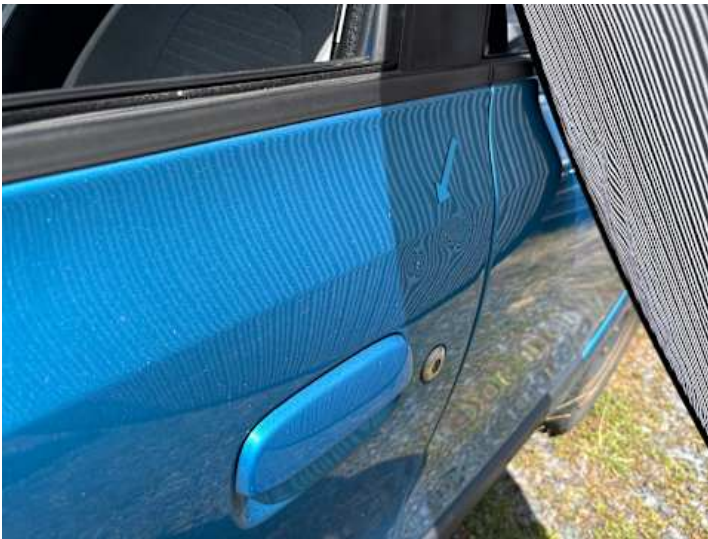
Fahrtür (Delle, Lackschaden)
