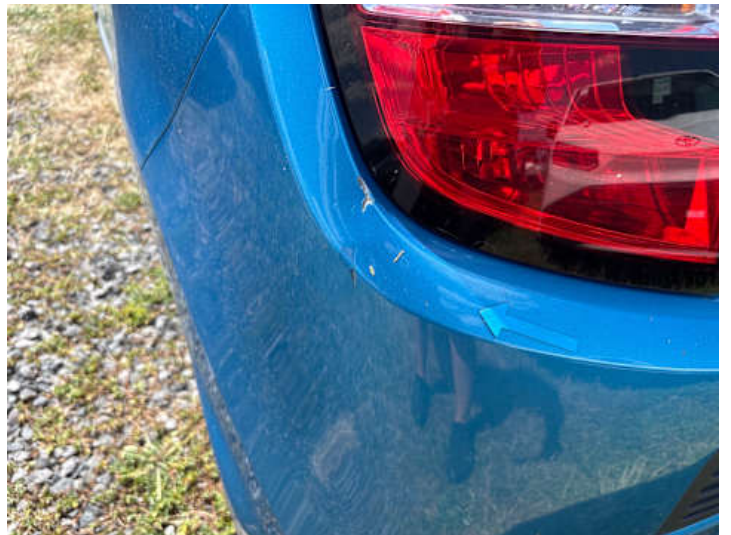
Stoßstange hinten (Verformung, Lackschaden)
