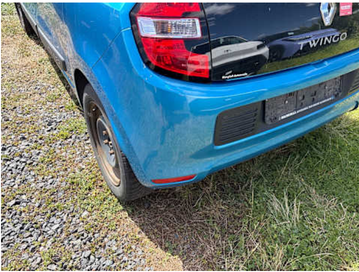
Stoßstange hinten (Verformung, Lackschaden)
