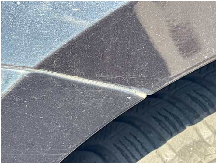
Stoßstange vorne (Kratzer, Lackschaden)
