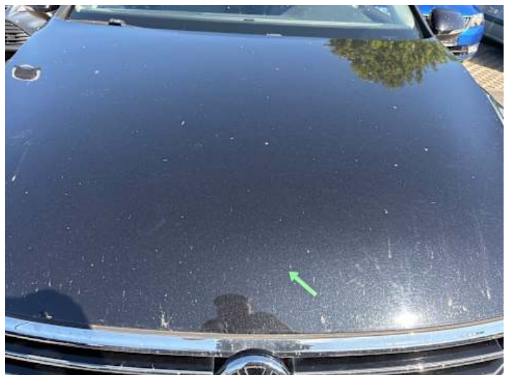
Motorhaube (Lackschaden, Steinschlag, Delle)
