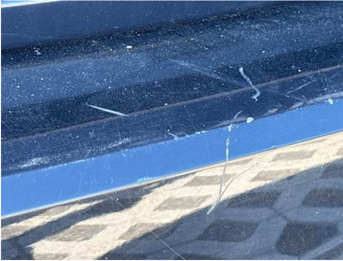
Stoßstange hinten (Kratzer, Lackschaden)
