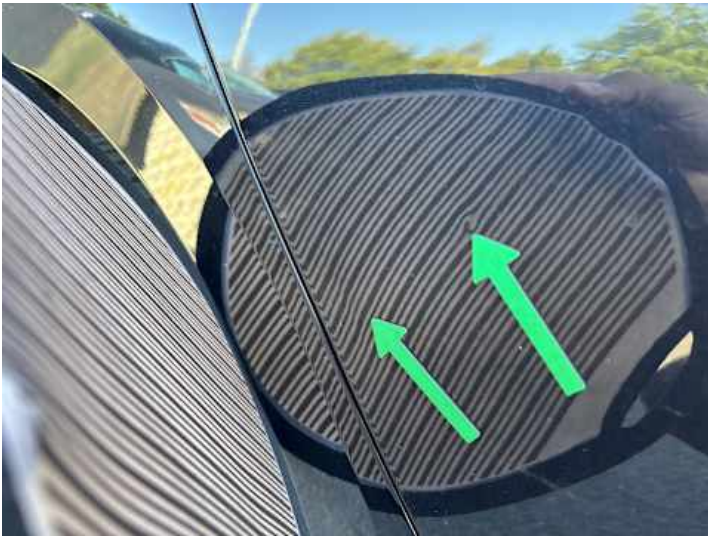
Türe hinten rechts (Delle, Verformung)
