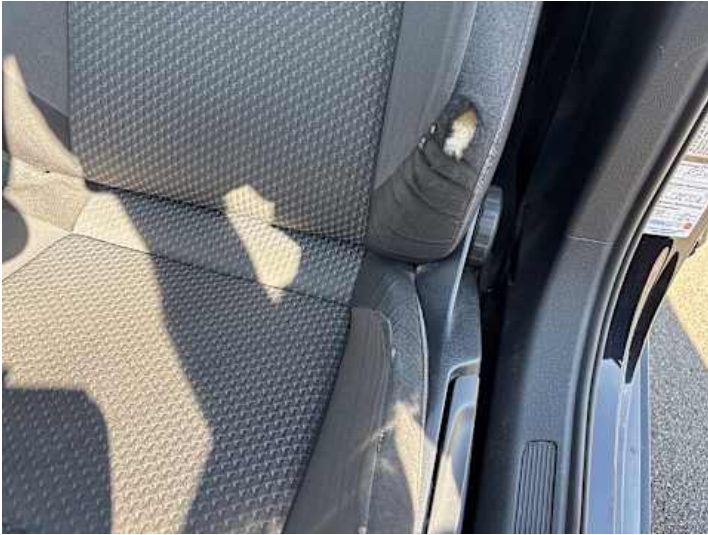
Innenraum (Kratzer, Verschleiß)
