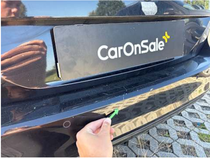
Stoßstange hinten (Kratzer, Lackschaden)
