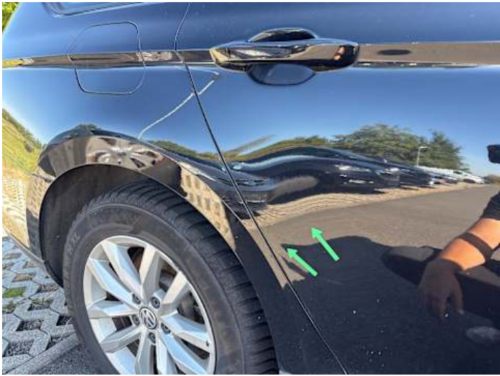
Türe hinten rechts (Delle, Verformung)
