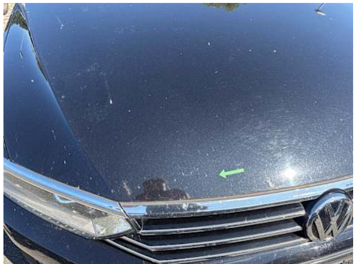
Motorhaube (Lackschaden, Steinschlag, Delle)
