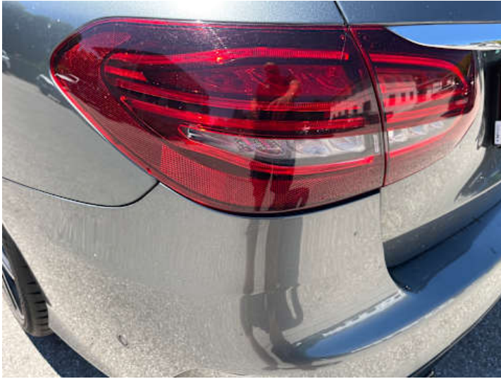
Stoßstange hinten (Spaltmaße ungenau)
